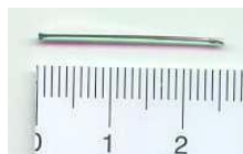
Obrázek 12: Koncová úprava silovým účinkem stříhání ocelového pásu [10]
