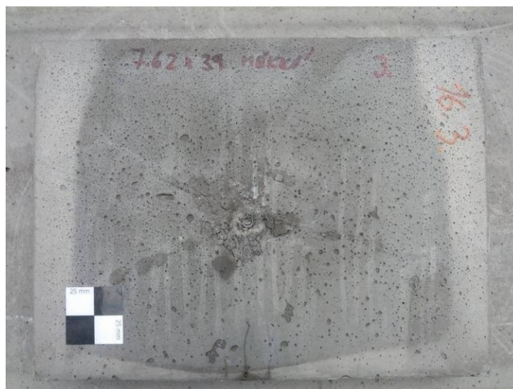
Obrázek 54: Projektil, uvíznutý v UHPFRC desce č. 3
