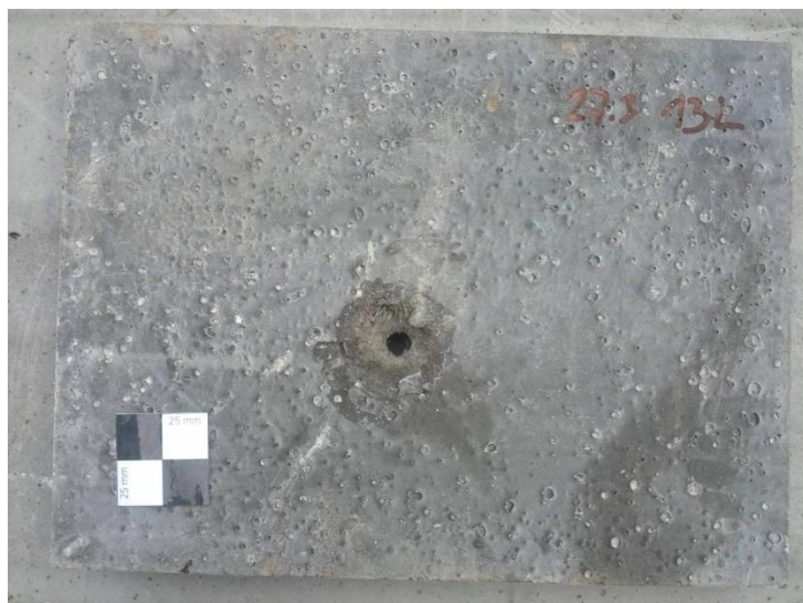
Obrázek 50: Celkový průstřel UHPFRC desky č. 13L
