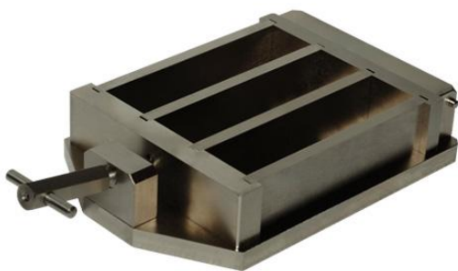
Obrázek 41: Forma na vzorky pro zkoušku v tahu za ohybu [34]
