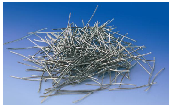
Obrázek 14: Ocelová mikrovlákna o průměru 0,15mm a délky 6 mm [13]
