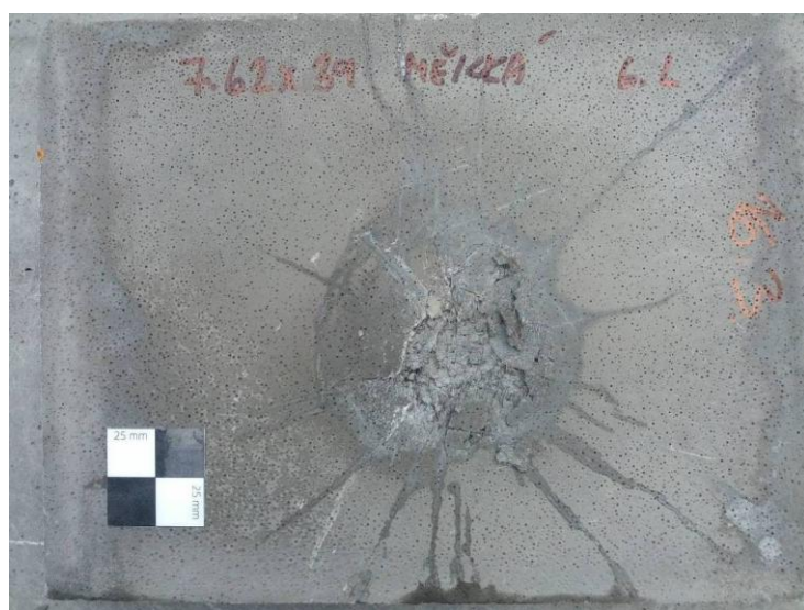
Obrázek 52: Vytržení materiálu ze zadní strany desky č. 6L vlivem tahového napětí
