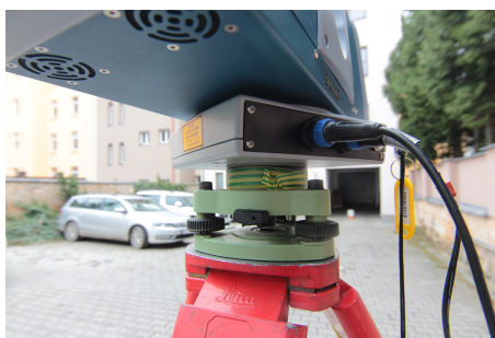
Obr. 5.9: Speciální nástavec pro upnutí skeneru do trojnožky
