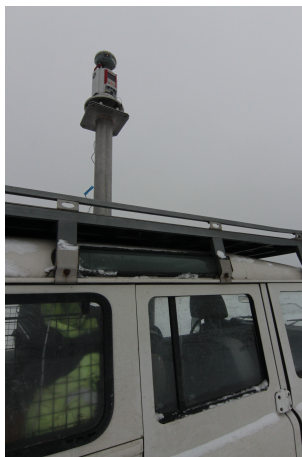
Obr. 2.4: Speciální nástavec pro skenování z auta
