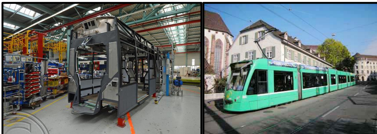
Obr. 5. Hrubá stavba tramvajového článku [7] / Combindo Basel sestavené ze 4 podvozkových a 3 nesených článků [8]
