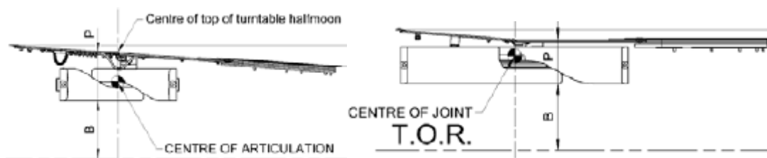
Obr. 18. Skloněné provedení / Provedení se zlomem [12]
