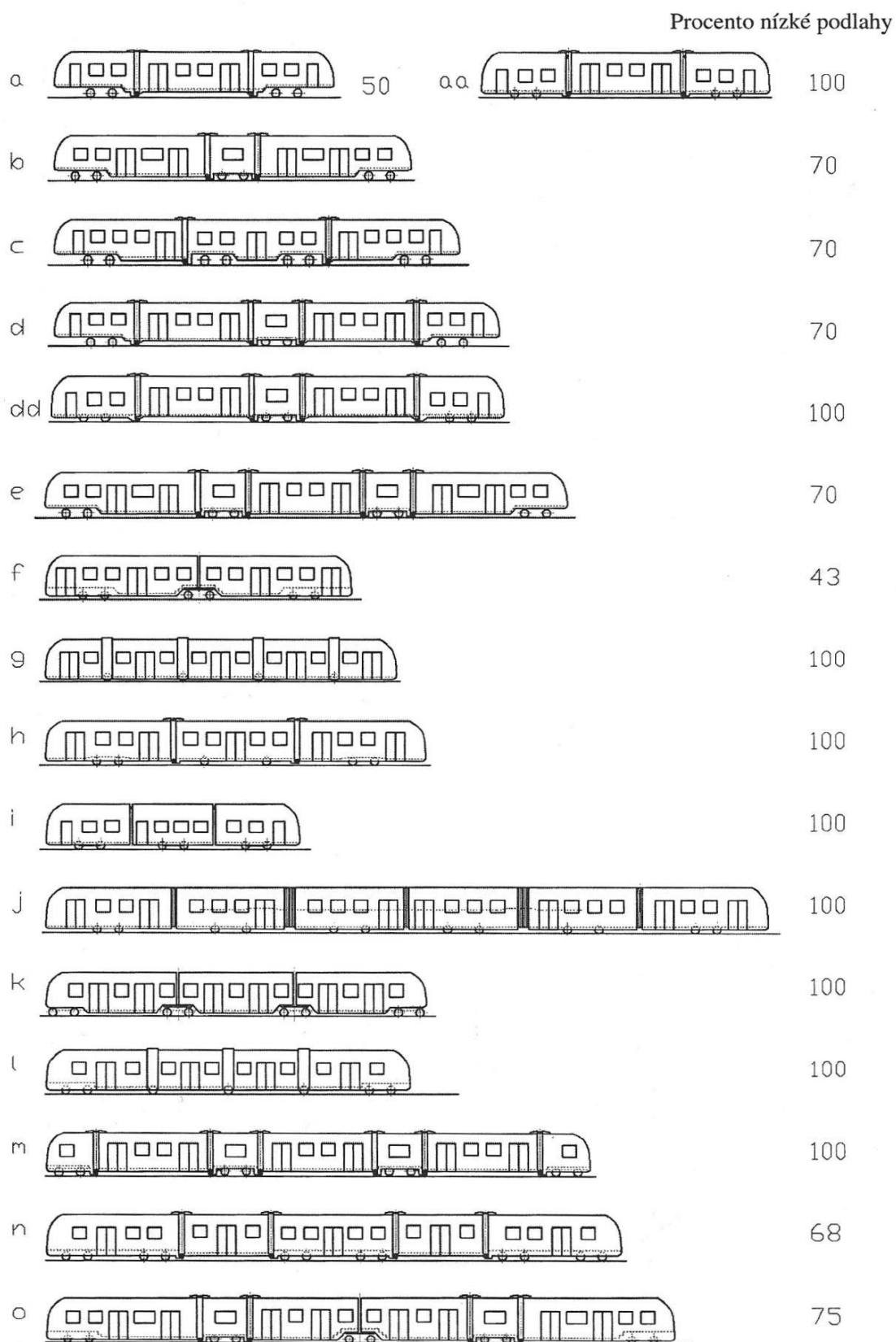
Obr. 29. Koncepce vícečlánkových tramvají [22]
