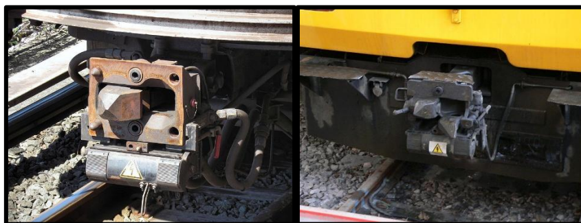
Obr. 14. Spřáhlo Tomlinson [18] / Typ BSI Compact [18]
