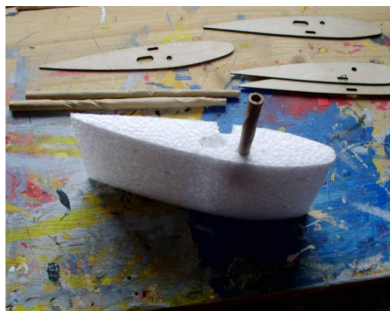
Obr. 101 Lepení uložení hlavního nosníku z duralové trubičky (Autor)
