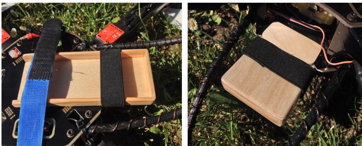
Obr. 139 Schránka pro uložení pohonných akumulátorů (Autor)
