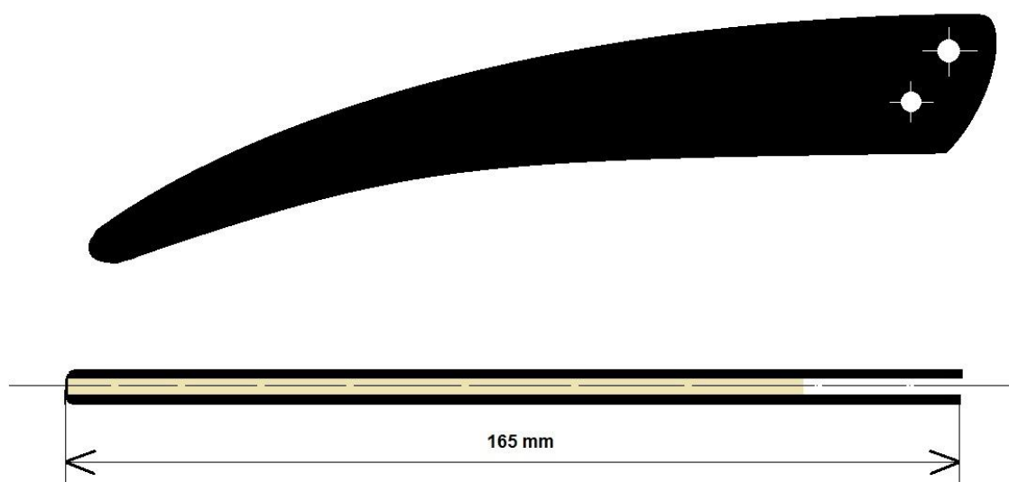
Obr. 134 Orientační výkres podvozkové nohy uhlík/balza (Autor)
