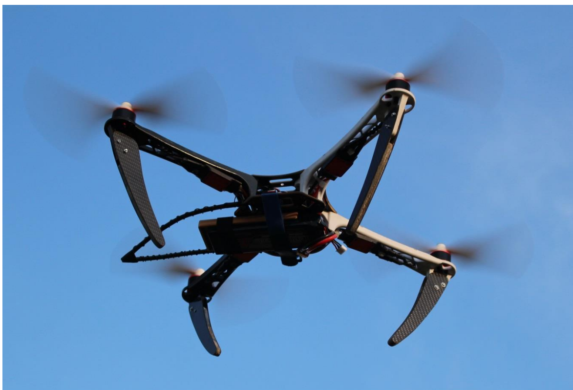
Obr. 138 Letové testování uhlíkovo/balzovového podvozku (Z. Raclavská)
