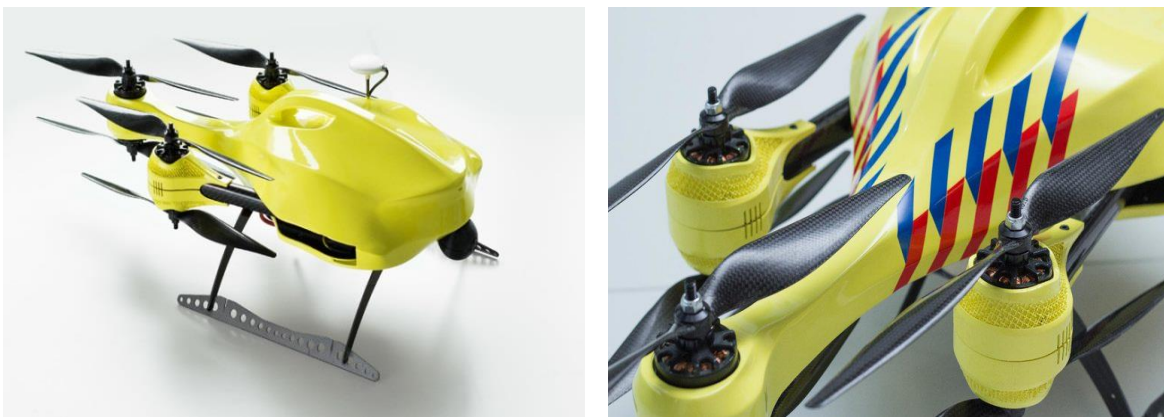
Obr. 41 Složený létající defibrilátor (alecmomont.com [33])
