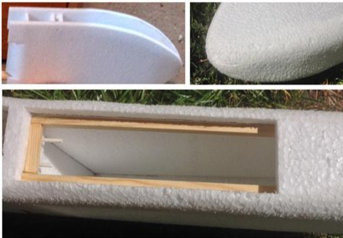
Obr. 81 Trupová gondola po hrubé kompletaci, přední část trupu po obroušení, střední části s vlepenými podélníky pro montáž akumulátorového poklopu (Autor)
