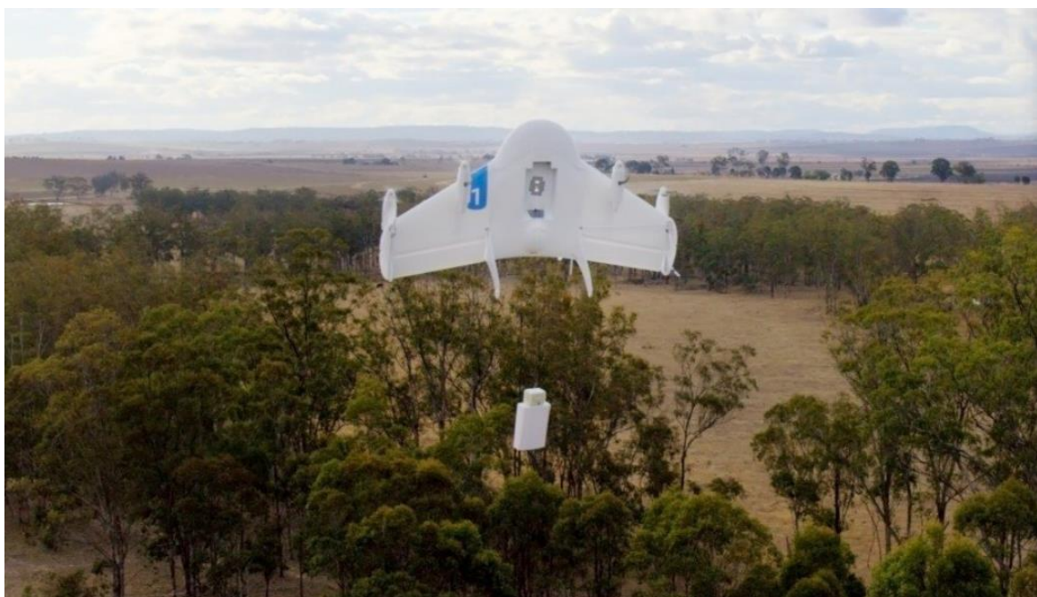
Obr. 49 Spouštění zásilky na navijáku, zatímco prostředek je ve visu, během prvního autonomního doručení v roce 2014 (Google Project Wing [38])
