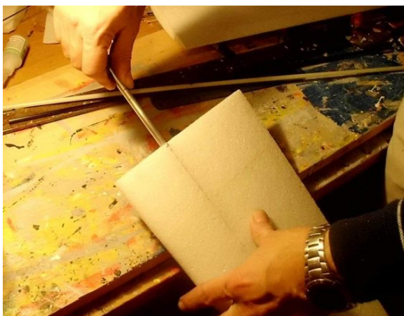
Obr. 101 Lepení uložení hlavního nosníku z duralové trubičky (Autor)
