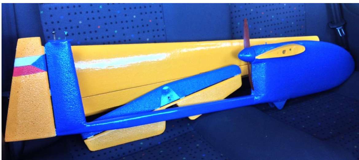
Obr. 117 Hotový model v rozloženém stavu, připravený k transportu (Autor)
