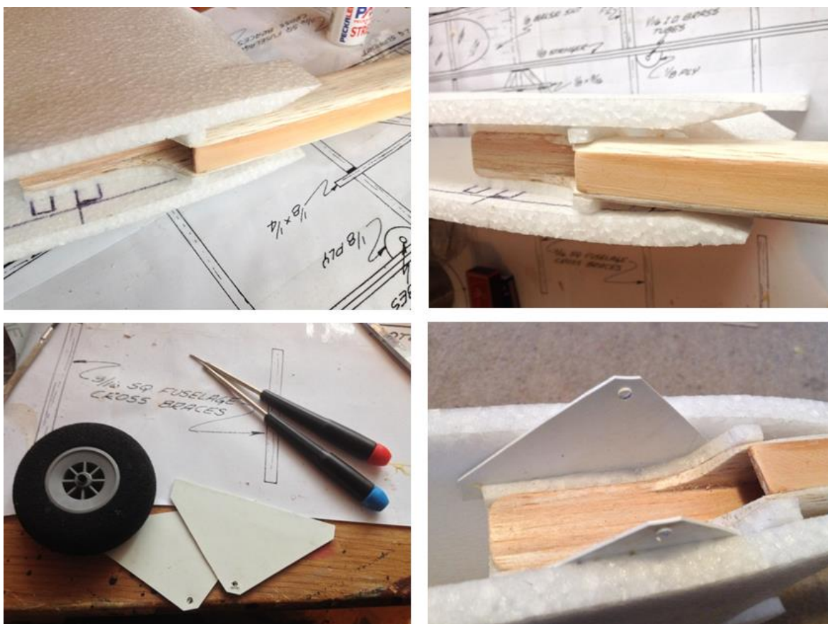
Obr. 88 Výroba uložení kola hlavního podvozku (Autor)
