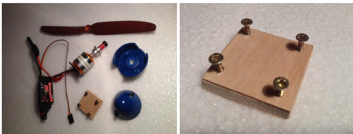
Obr. 111 Pohonná jednotka a motorové lože (Autor)
