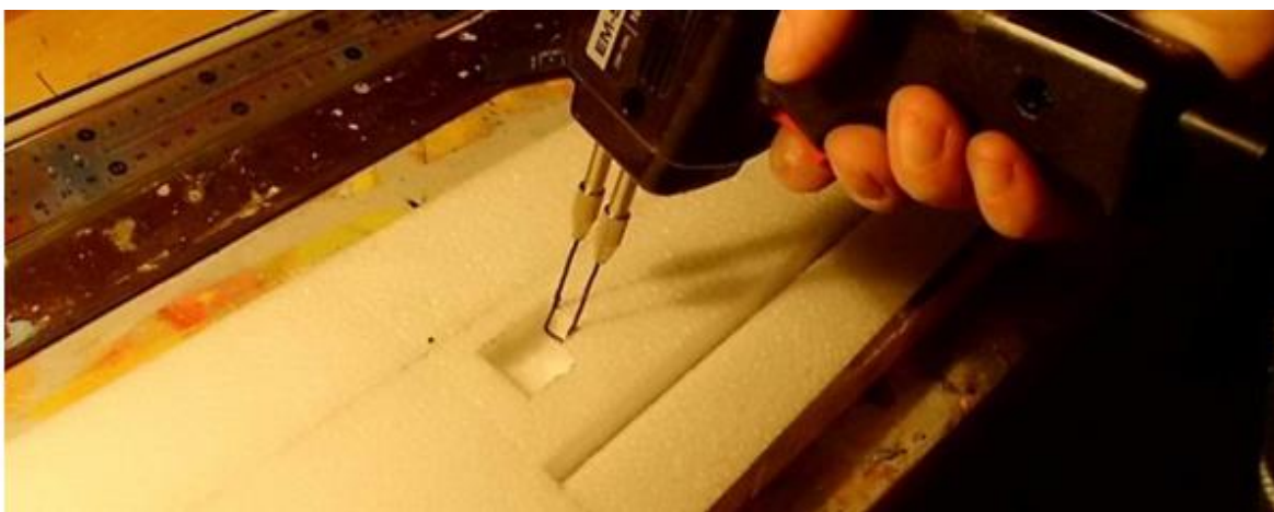
Obr. 106 Způsob vypalování montážních otvorů pro serva křidélek (Autor)
