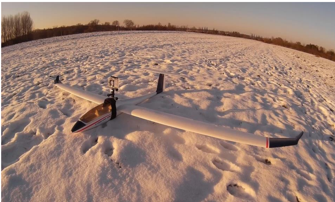
Obr. 67 Montáž kamery na trupu, pohled vpřed (Autor, Arcus E)
