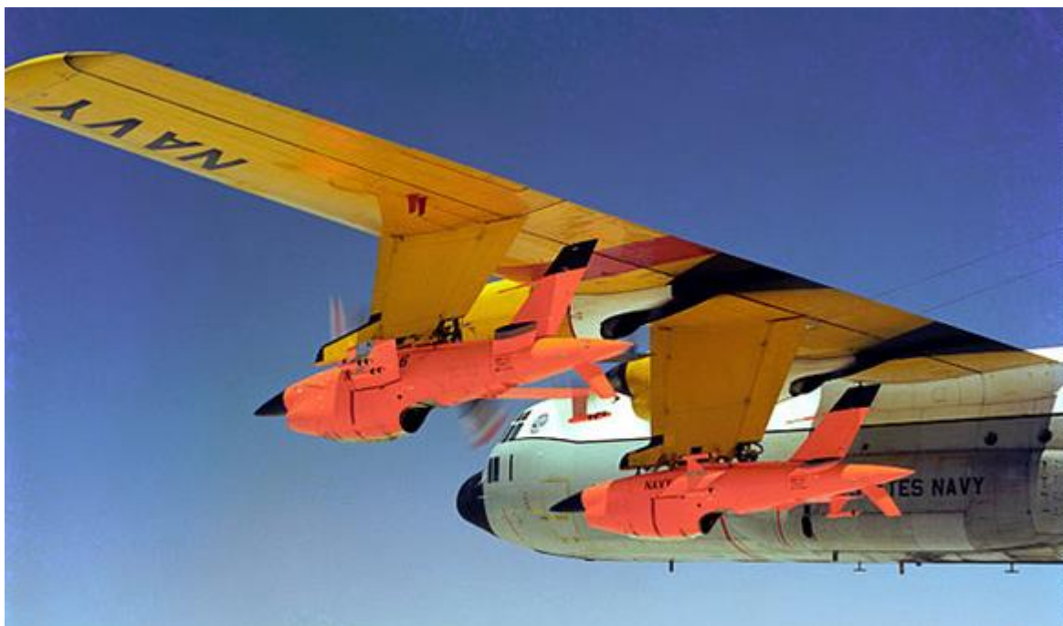
Obr. 15 Letoun DC-130 nese na podvěsích dva drony pro letecký průzkum Ryan Firebee (understandingempire.wordpress.com [4])
