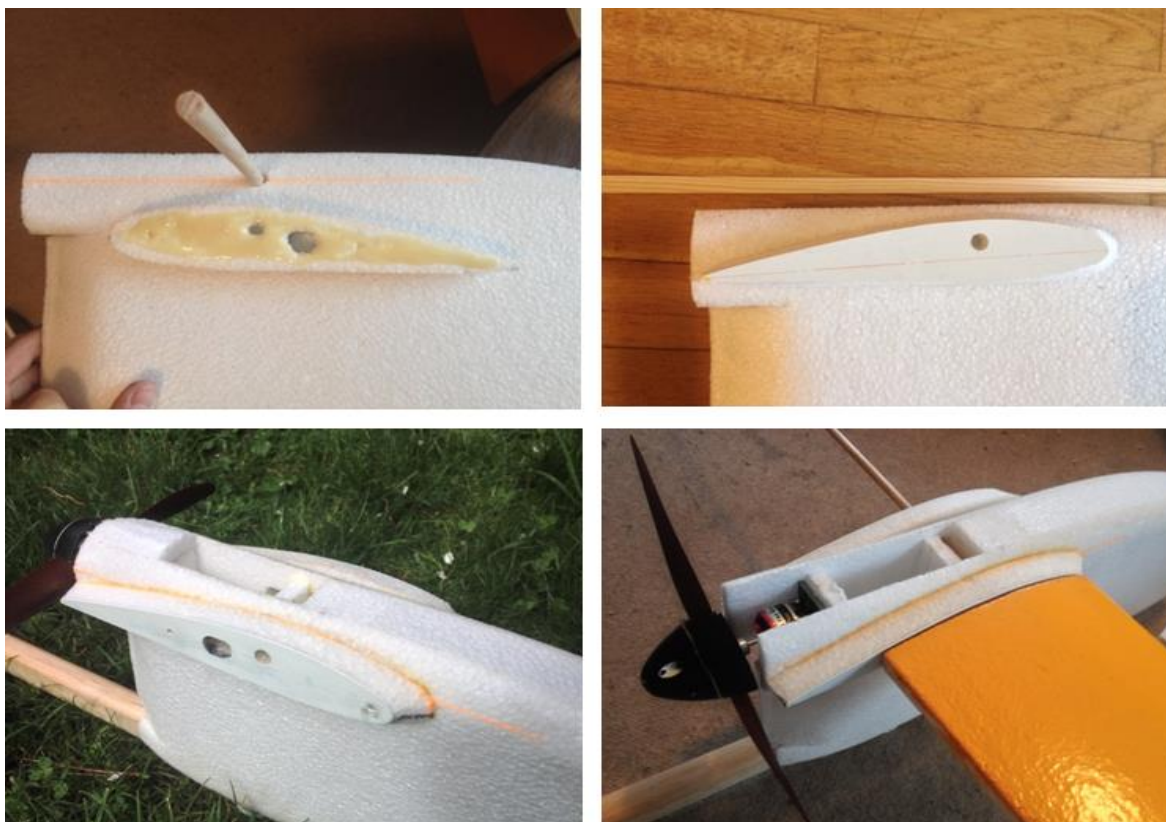
Obr. 98 Lepení centroplánu k trupové gondole (Autor)
