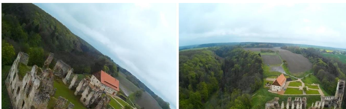
Obr. 151 Porovnání polohy horizontu v náklonu, před/po montáži gimbalu (Autor)
