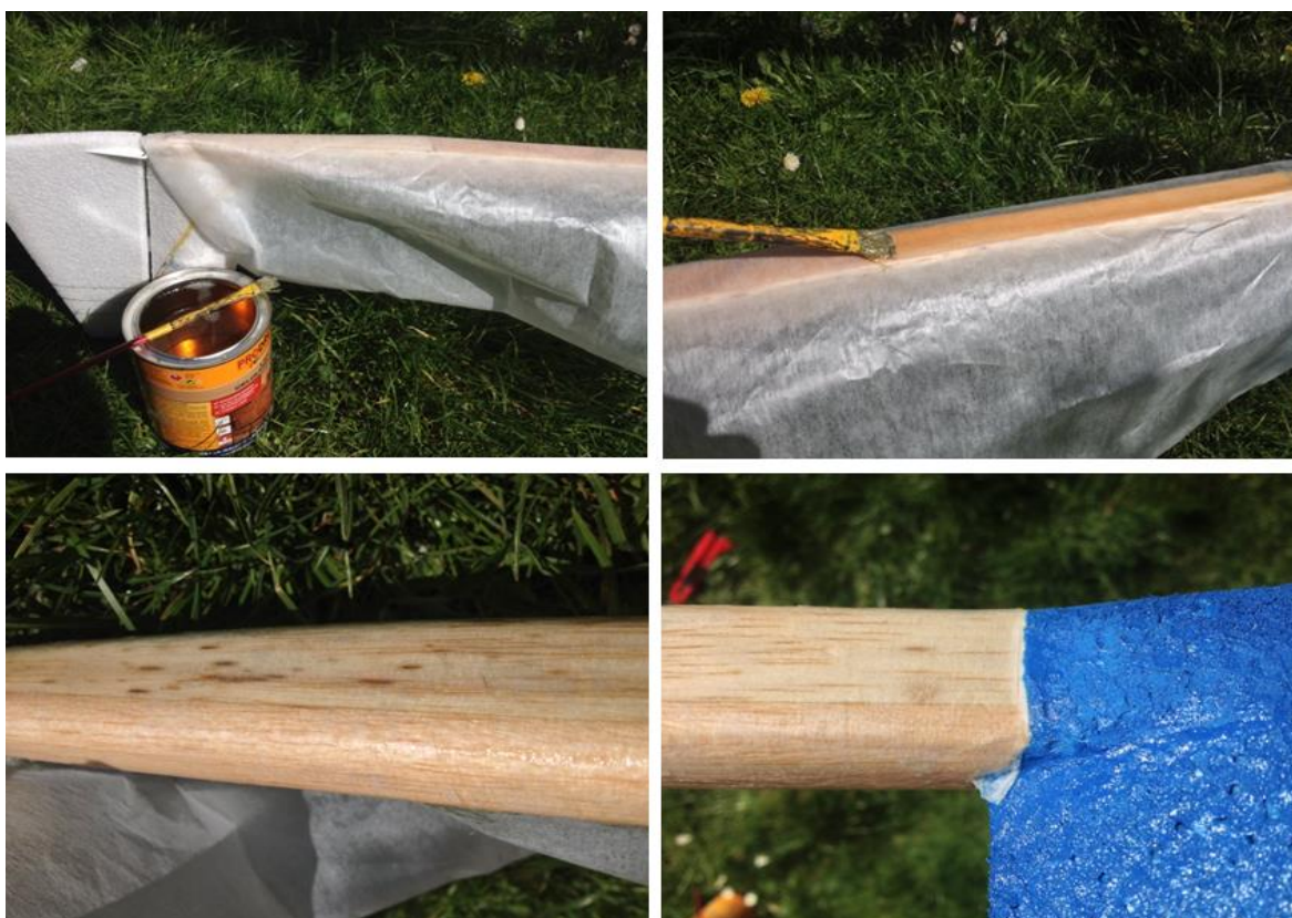
Obr. 96 Lepení potahu nosníku ocasních ploch (Autor)
