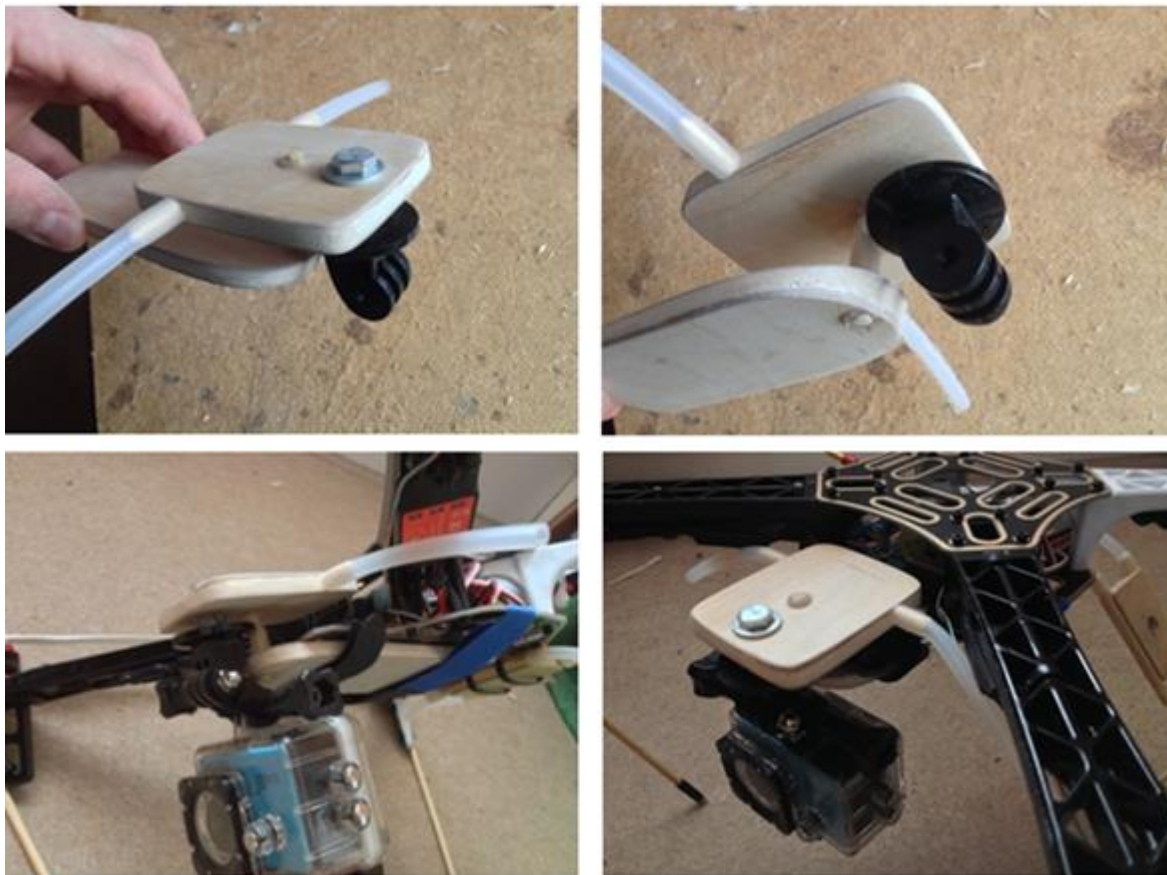
Obr. 148 Přišroubovaná redukce pro uchycení kamery, montáž serv a pokusné přichycení gimbalu do konstrukce quadrokoptéry (Autor)
