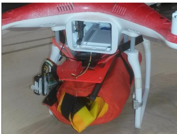
Obr. 35 Platforma Ryp tide pro připevnění a dálkový odhoz složeného samonafukovacího člunu (dronelife.com, popularscience.com [27], [28])
