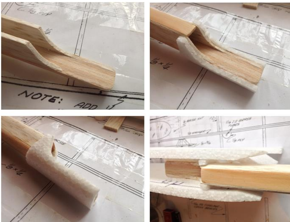
Obr. 85 Vyřiznutí lože pro hlavní podvozkové kolo, výroba uložení pro vlepení nosníku ocasních ploch do trupové gondoly (Autor)
