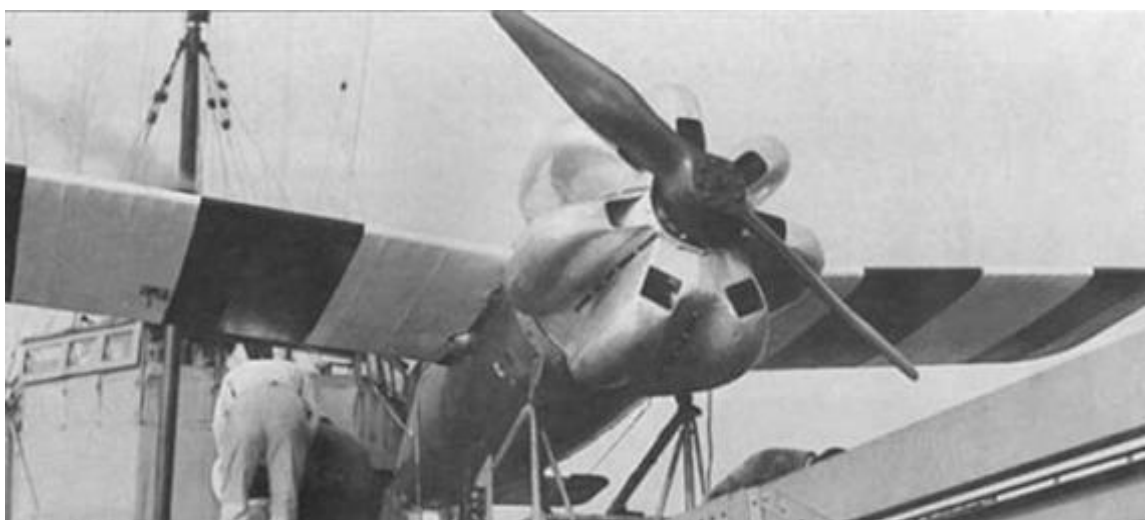
Obr. 4 Zástavba motoru Lynx ve stroji RAE Larynx (vintagewings.ca [3])
