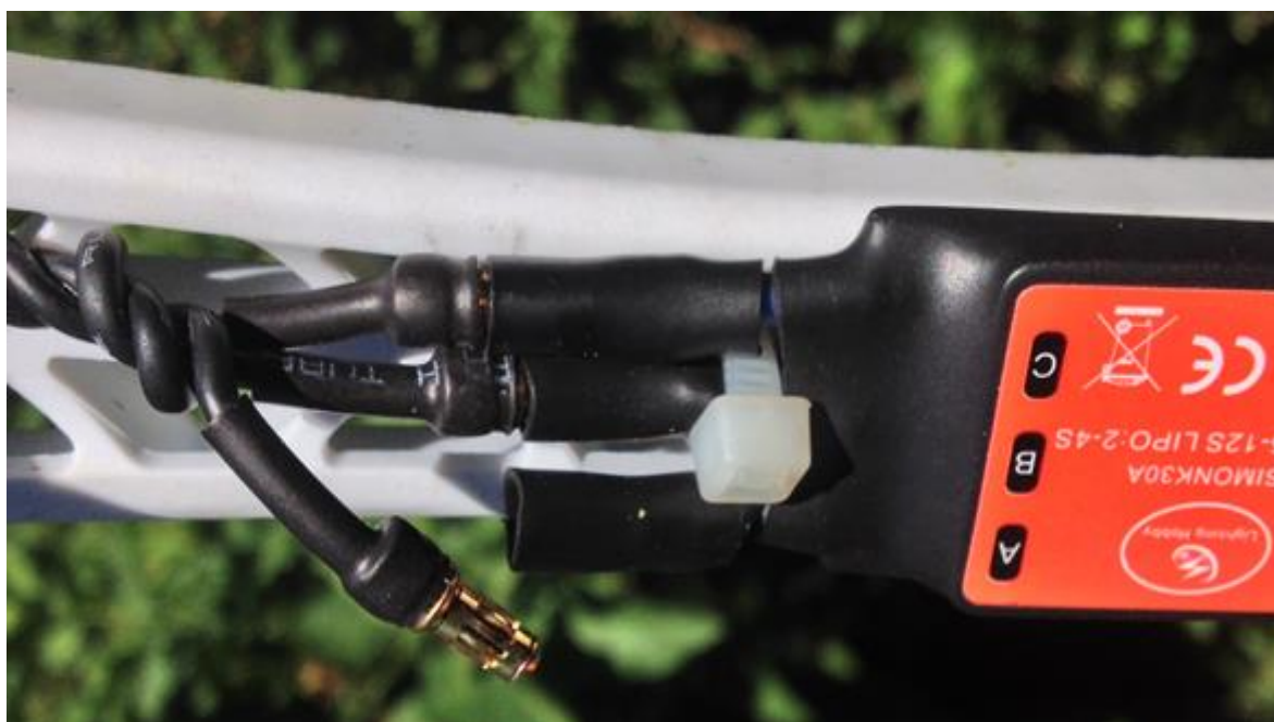
Obr. 126 Konektory pro spojení regulátoru s elektromotorem (Autor)
