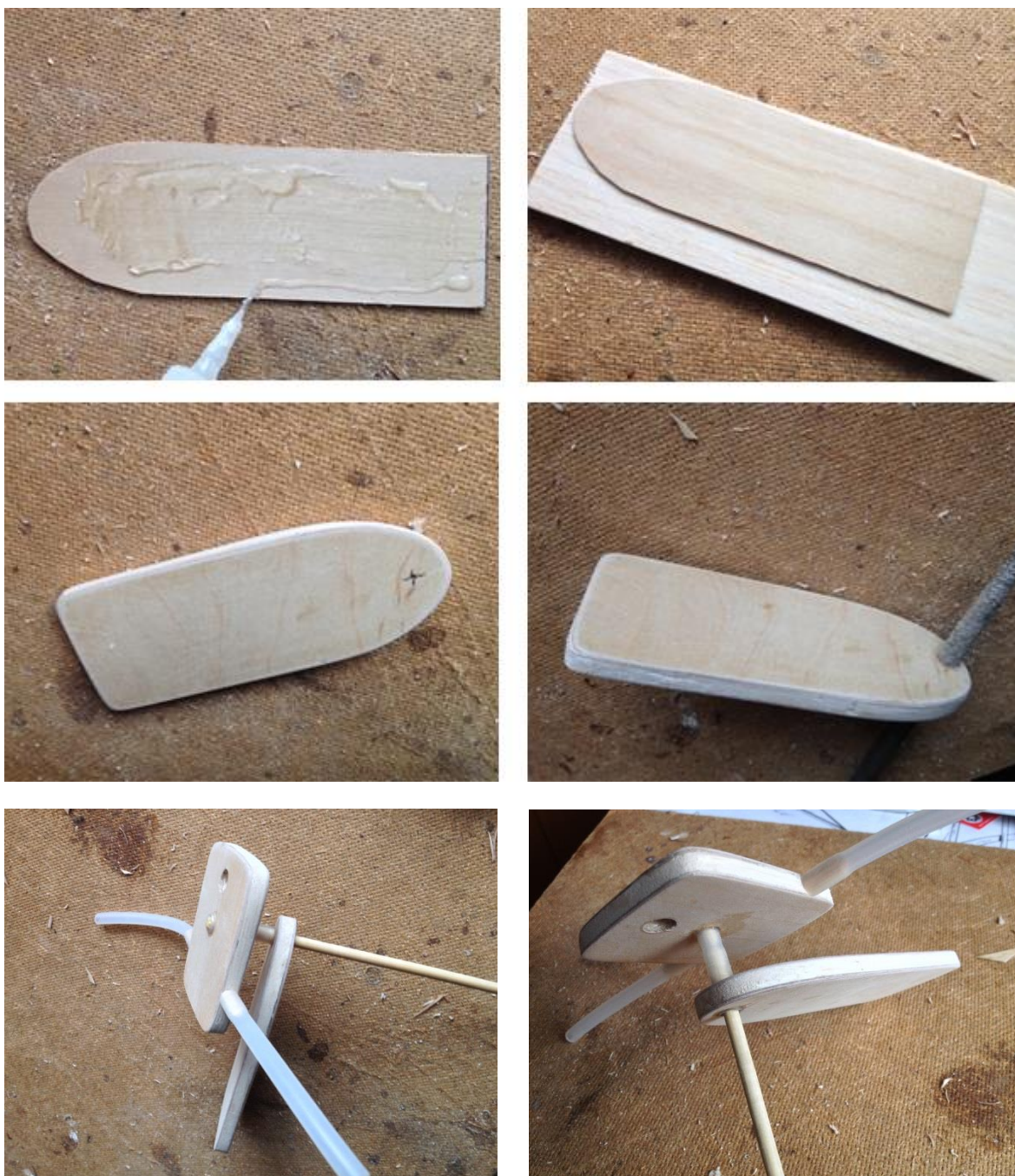
Obr. 147 Stavba základové desky pro uchycení serv a její spojení s deskou kamery (Autor)
