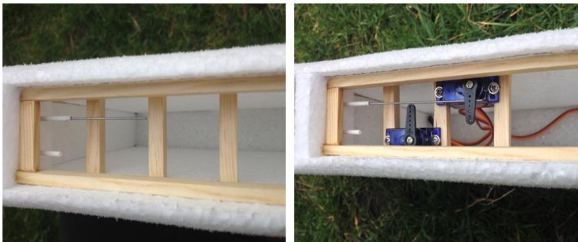
Obr. 112 Montáž serv pro náhon ocasních kormidel (Autor)
