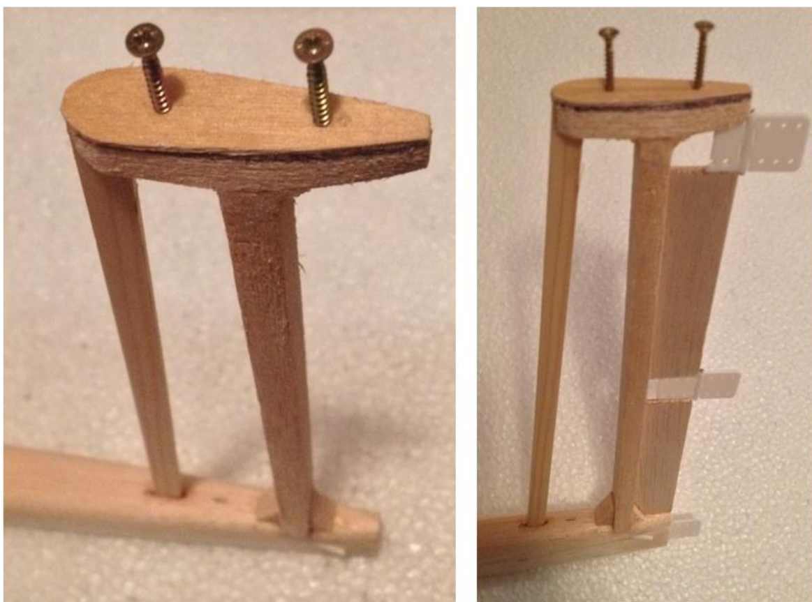
Obr. 90 Uchycení vodorovné ocasní plochy a směrového kormidla (Autor)
