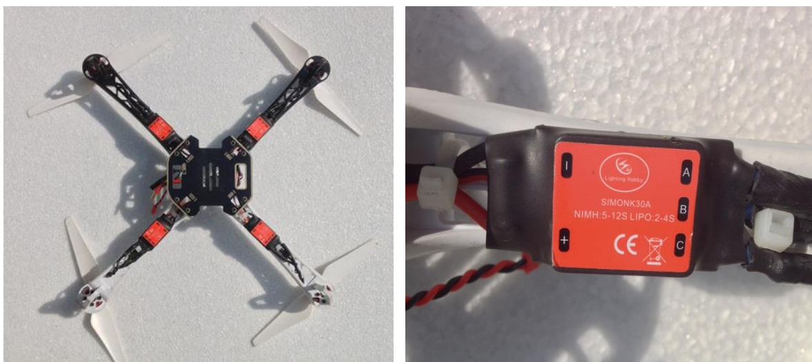
Obr. 127 Připevnění regulátorů otáček ke konstrukci modelu (Autor)
