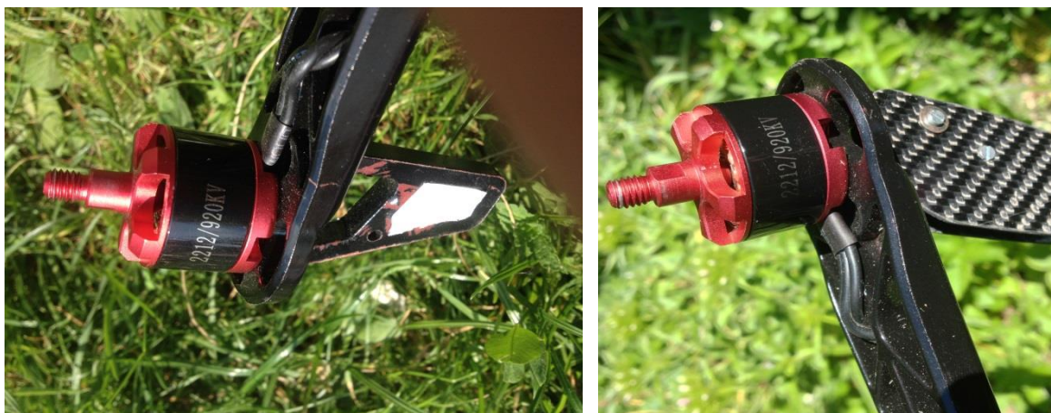
Obr. 137 Výplň části rámu z EPP a montáž p. nohou pomocí šroubů (Autor)
