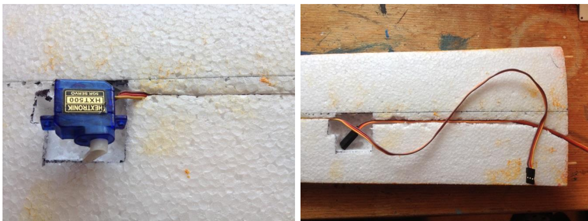
Obr. 113 Vedení kabeláže k servům v křídlech (Autor)
