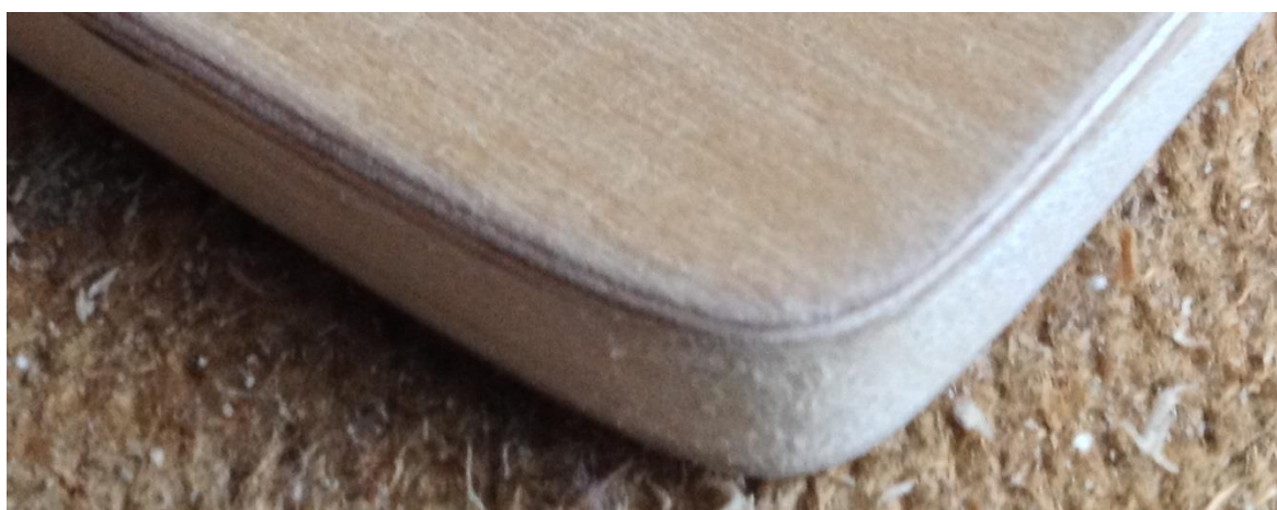
Obr. 144 Sendvičová konstrukce balza-překližka (Autor)
