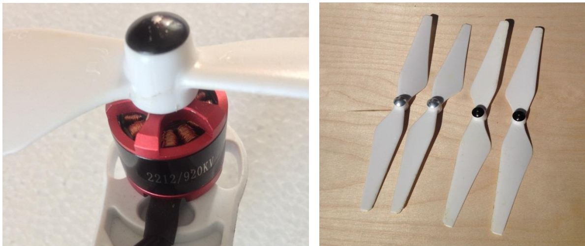
Obr. 125 Elektromotor SIMONK 2212/920kV s vrtulí DJI 10x4.5in (Autor)
