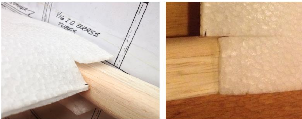
Obr. 86 Vlepení nosníku ocasních ploch do trupové gondoly (Autor)
