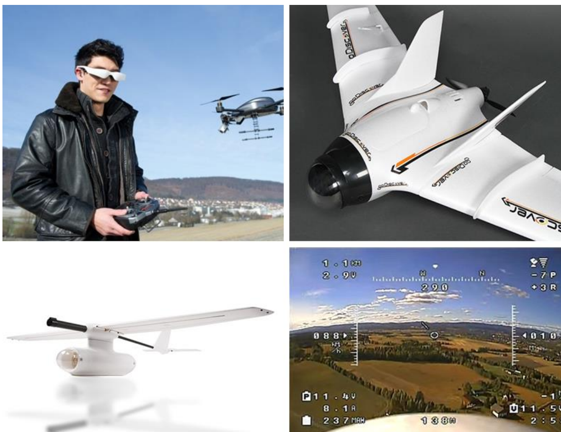
Obr. 54 FPV quadrokoptéra, samokřídlo, letoun a výnos do brýlí (Hobby King [39])
