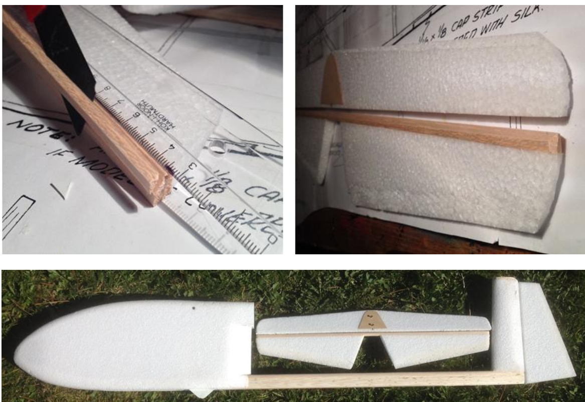
Obr. 94 Stavba vodorovné ocasní plochy (Autor)
