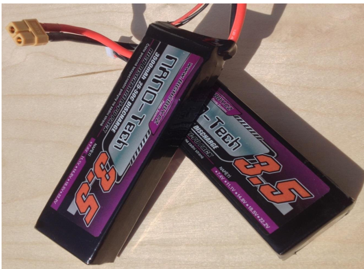
Obr. 129 Akumulátorové sady LiPol 3S1P 3500mAh, používané v modelu (Autor)
