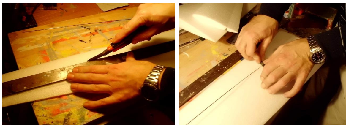
Obr. 100 Vyříznutí drážky podél rozpětí křídel a zalepení uhlíkových pásnic (Autor)
