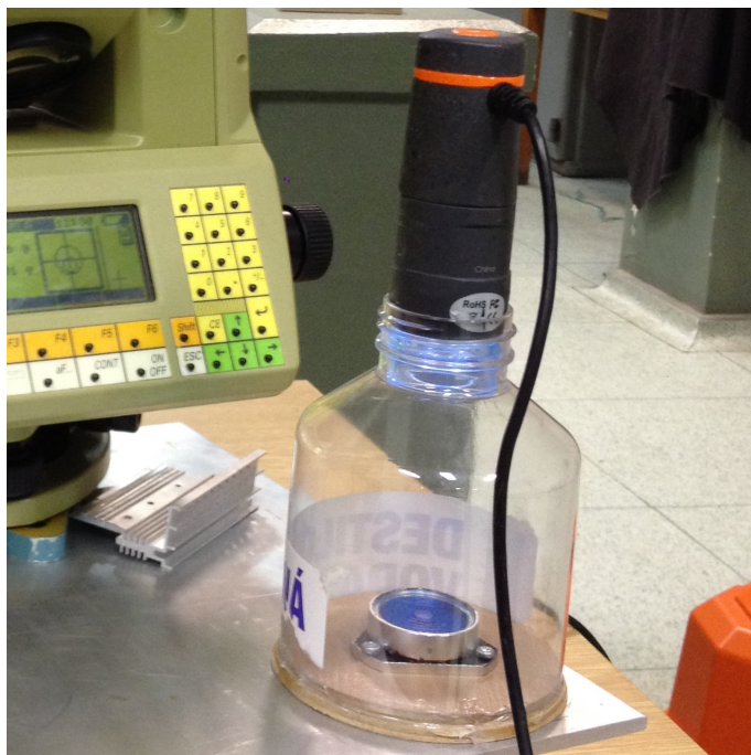
Obrázek 10.5: Upevnění mikroskopu v láhvi
