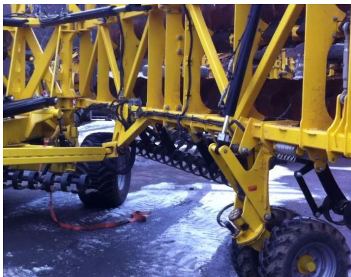
Obr. 49 Podpěrné kolo při rozkládání, resp. skládání stroje
