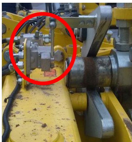
Obr. 47 Mechanický rozváděč „RD“
