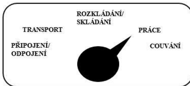
Obr. 6 Ovládací panel režimů umístěný v kabině traktoru
