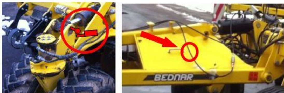
Obr. 44 Vlevo návrh umístění jednoho z koncových spínačů „F“ a „G“, vpravo tlakového spínače „E“
