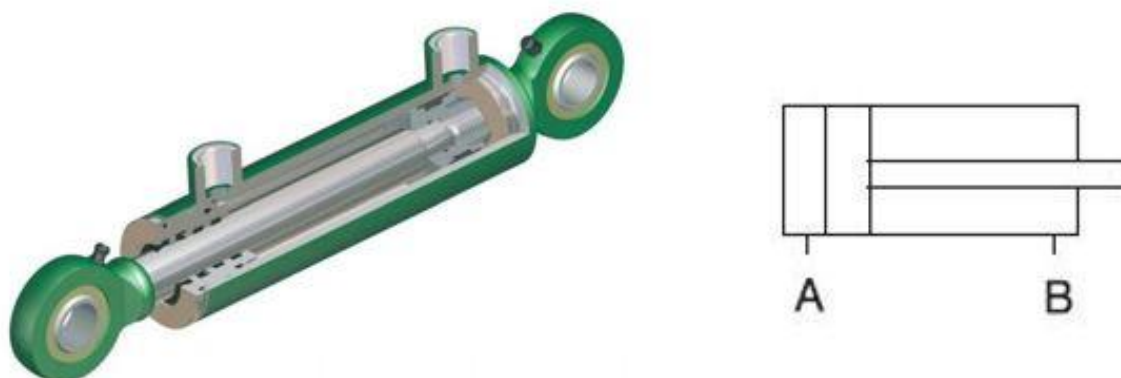
Obr. 29 Vlevo přímočarý dvojčinný hydromotor s jednostrannou pístnicí [12]. Vpravo schématická značka [7]
