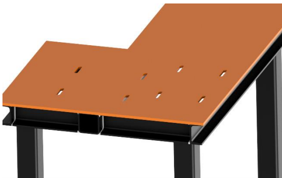
Obrázek 31: Deska s oválnými dírami pro šrouby
