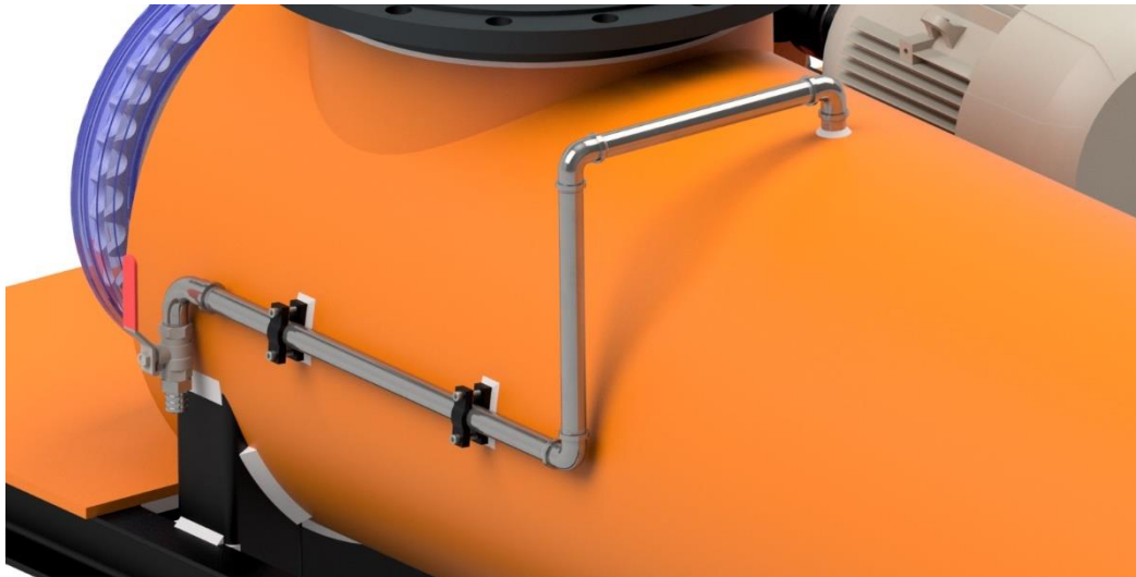
Obrázek 35: Přívod záměšové vody do míchacího bubnu
