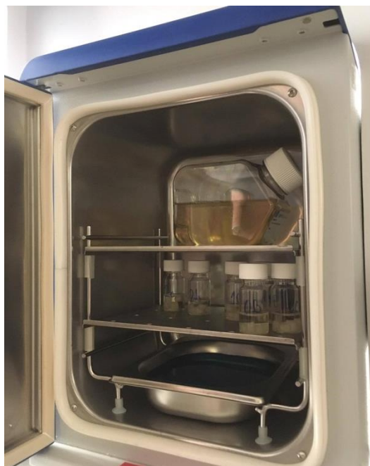
Obrázek 10 - Inkubátor na hydratované vzorky pro udržení stanovených podmínek
