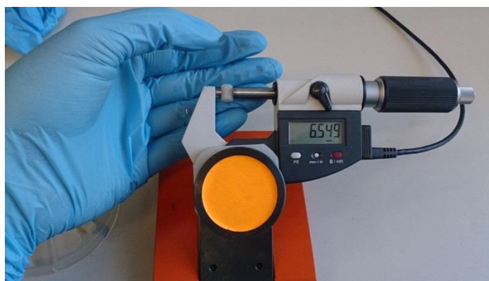
Obrázek 15 - Měření hydratovaného vzorku před zatěžováním
