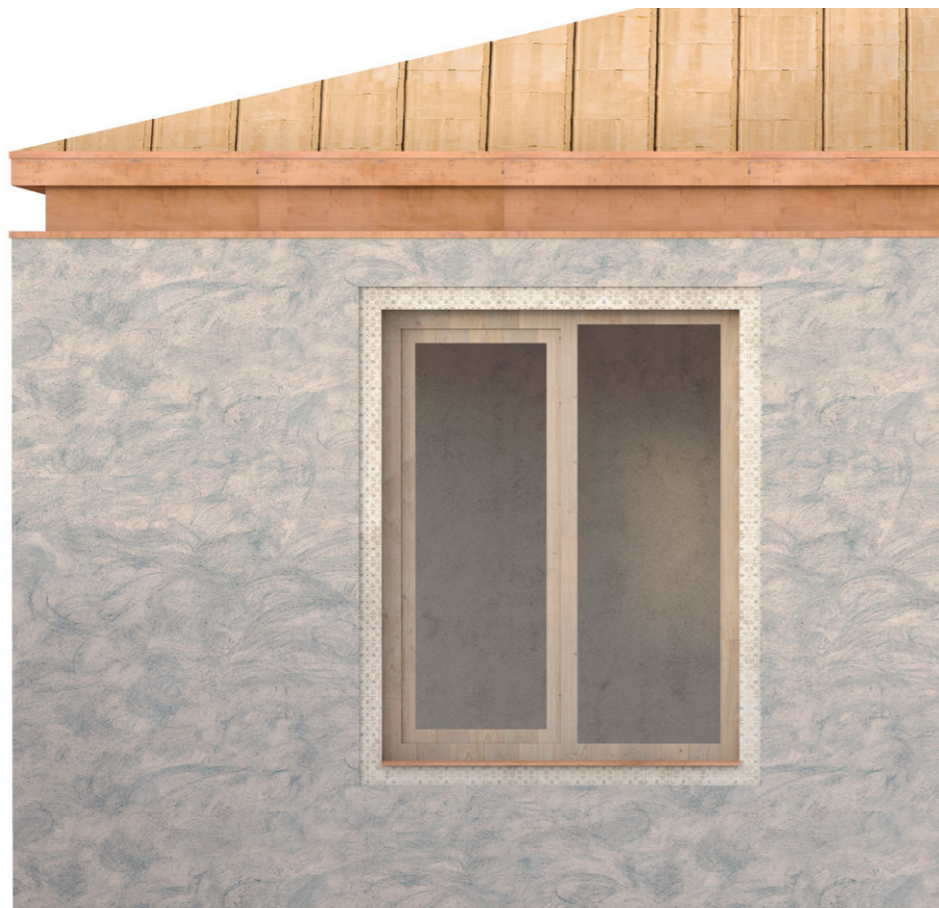
detail okna se zapuštěnou šambránou s naválečkovaným vzorem
