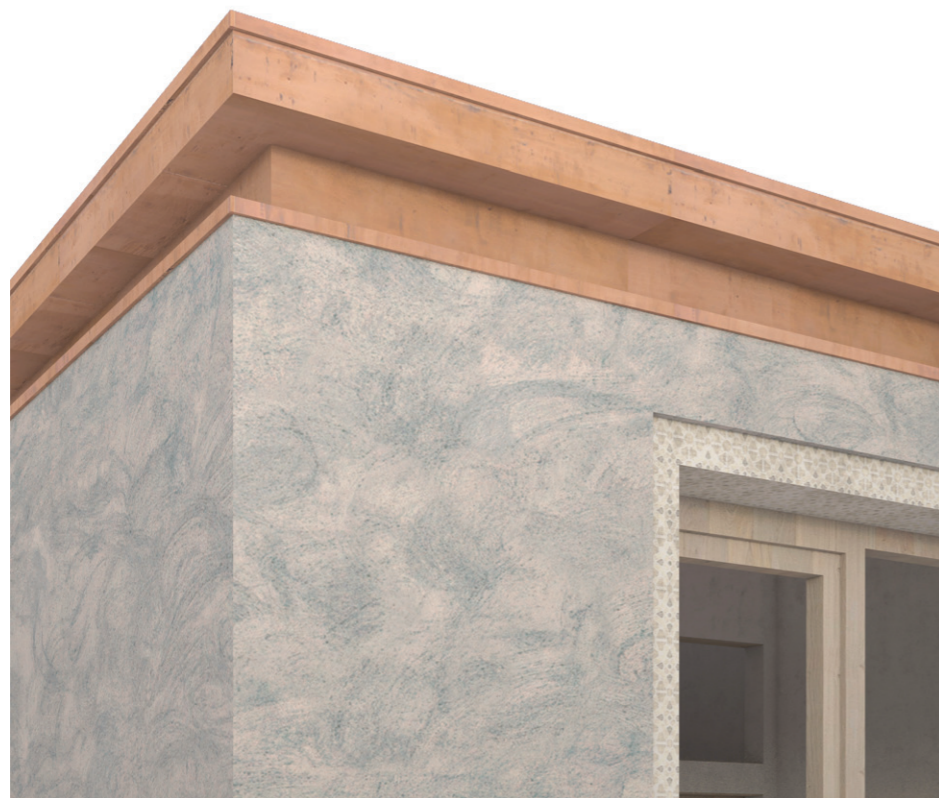
detail klempířsky provedené korunní římsy ve které je skrytý okapní žlab
