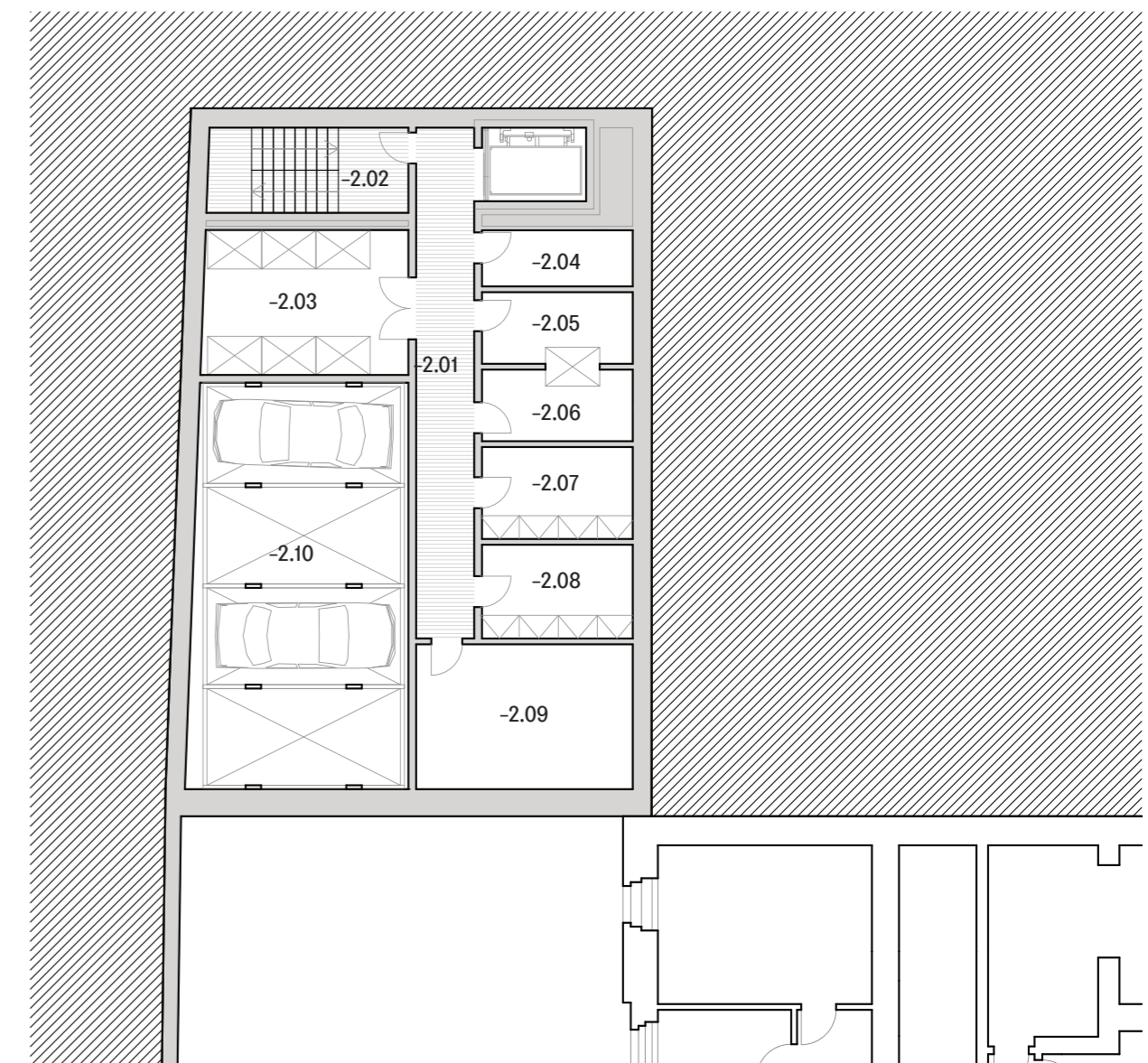
1.NP VSTUPNÍ PODLAŽÍ -2.01 chodba / -2.02 únikové schodiště / -2.03 sklad odpadů / -2.04 sklad biologického odpadu / -2.05 špinavá prádelna / -2.06 čistá prádelna / -2.07 sklad / -2.08 sklad / -2.09 technická místnost / -2.10 parkovací výtahy
