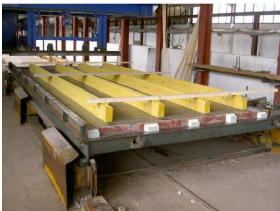
Obr. 9: Výroba a montáž prefabrikovaného dřevobetonového stropu [4]
