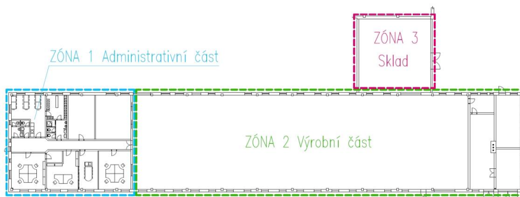
Obr. 15: Půdorys objektu s vyznačenými zónami [2]
