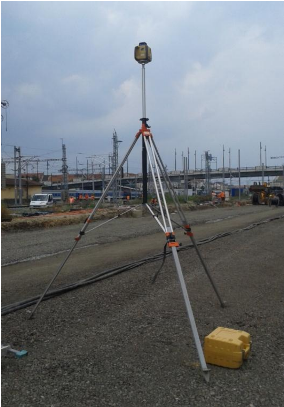
Obr. 4.6 - Umístění rotačního laseru
