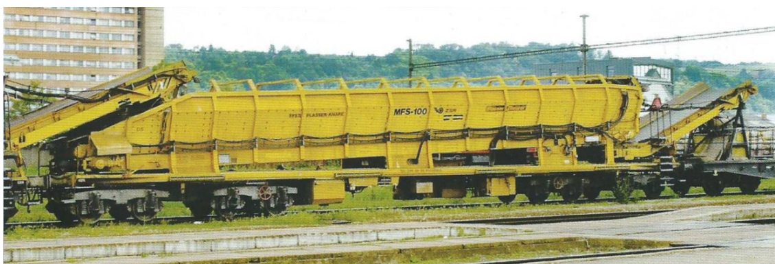
Obr. 5.9 - Zásobovací vůz typu MFS 100 [23]
