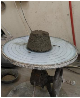
Obr. 22: Sednutí kužele referenčního vzorku s vodním součinitelem 0,52. [35]
