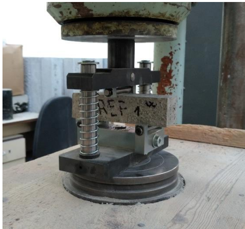
Obr. 27: Trámeček vhodně umístěný v lisu. [35]
