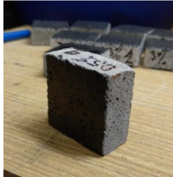
Obr. 31: Vzorek s CF příměsí potřený uhlíkovou pastou. [35]
