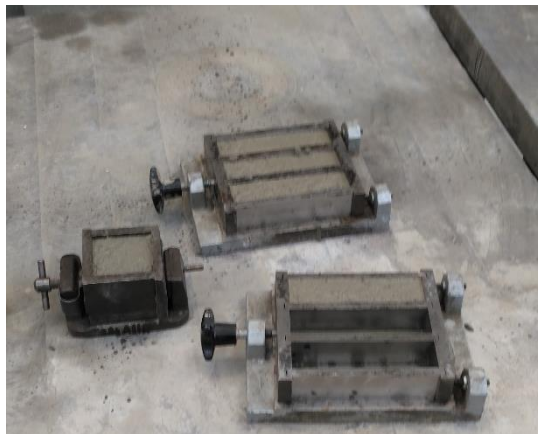
Obr. 23: Vzorky na vibračním stole. [35]
