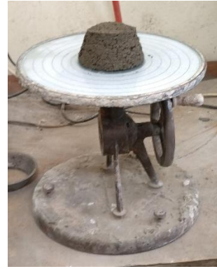
Obr. 21: Sednutí kužele referenčního vzorku s vodním součinitelem 0,4. [35]
