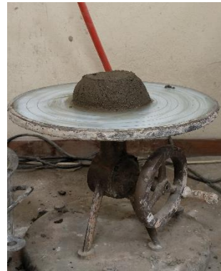
Obr. 22: Sednutí kužele referenčního vzorku s vodním součinitelem 0,52. [35]
