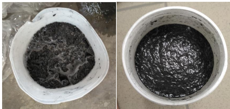
Obr. 19: Srovnání zhomogenizovaných uhlíkových vláken. Nekvalitně zhomogenizované (vlevo), kvalitně zhomogenizované (vpravo). [35]
