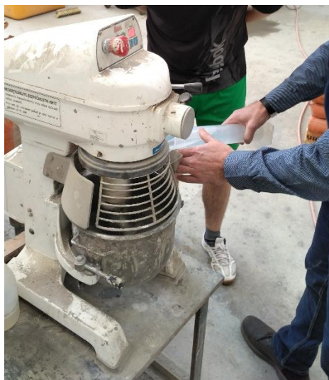
Obr. 20: Přidávání vody k rozmíchanému cementu s pískem. [35]
