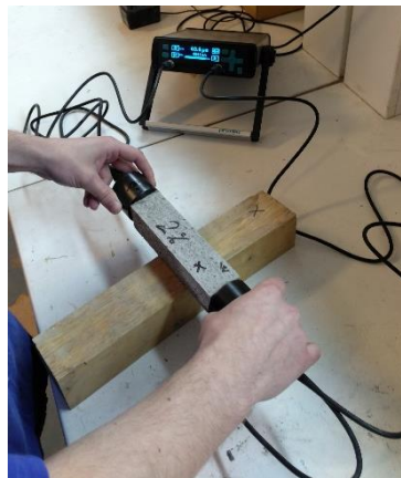
Obr. 25: Měření dynamického modulu pomocí ultrazvuku. [35]
