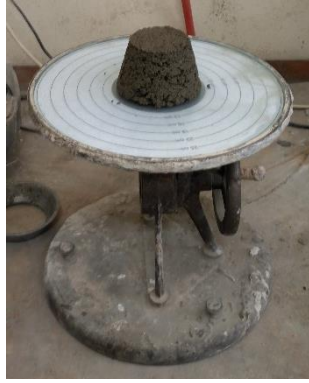
Obr. 21: Sednutí kužele referenčního vzorku s vodním součinitelem 0,4. [35]
