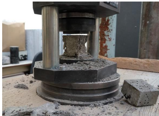
Obr. 29: Vzorek po zkoušce pevnosti v tlaku. [35]
