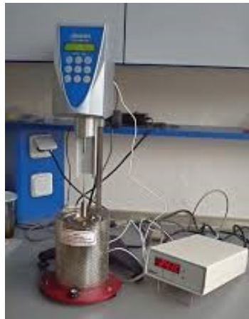
Obr. 18 Rotační viskozimetr (BrookfieldDV-II+Pro)
