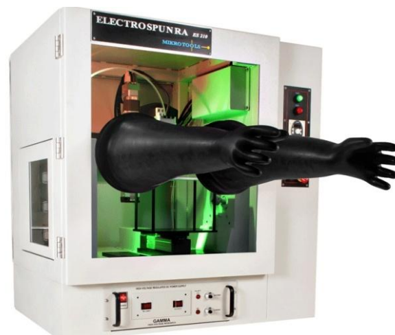
Obr. 6: Přístroj Electrospunra ES-210 (Mikrotools) využívaný na Oddělení kompozitních a uhlíkových materiálů AV ČR
