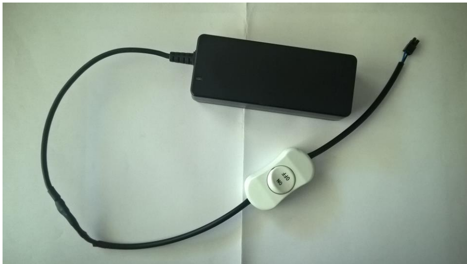
Obrázek 11: Upravený předřadník se šňůrovým vypínačem
