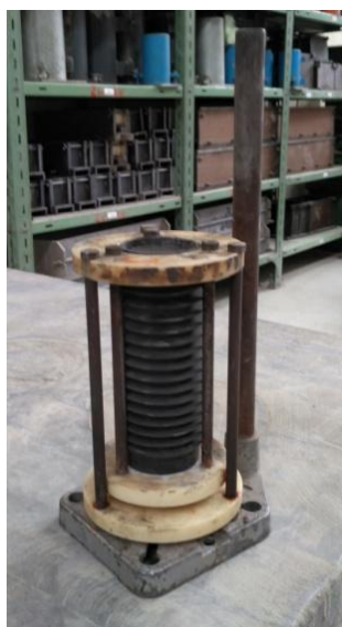
Obr. 41: Aparatura pro měření objemových změn, tzv. vlnovec [37]
