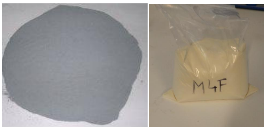
Obr. 21: Použitá příměs mikrosilika a použitá přísada carboxylether [37]
