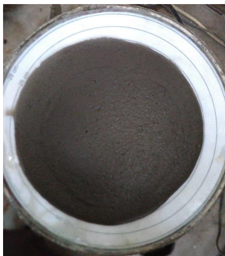
Obr. 29: Rozlití směsi 5 na střešacím stolku za 1 minutu [37]
