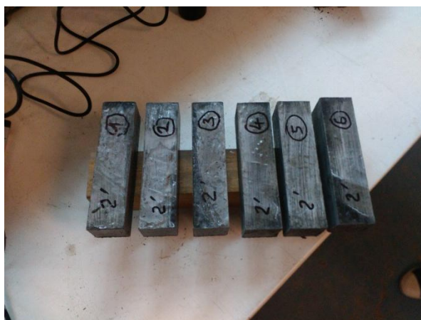
Obr. 37: Vorky před zkouškou ultrazvukem [37]
