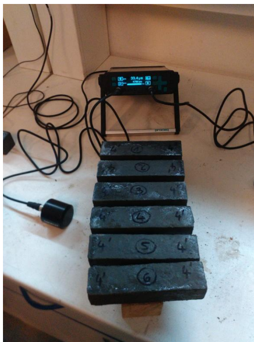
Obr. 34: Nedestruktivní zkouška pomocí ultrazvuku [37]
