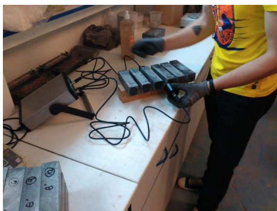
Obr. 38: Měření ultrazvukovým přístrojem [37]
