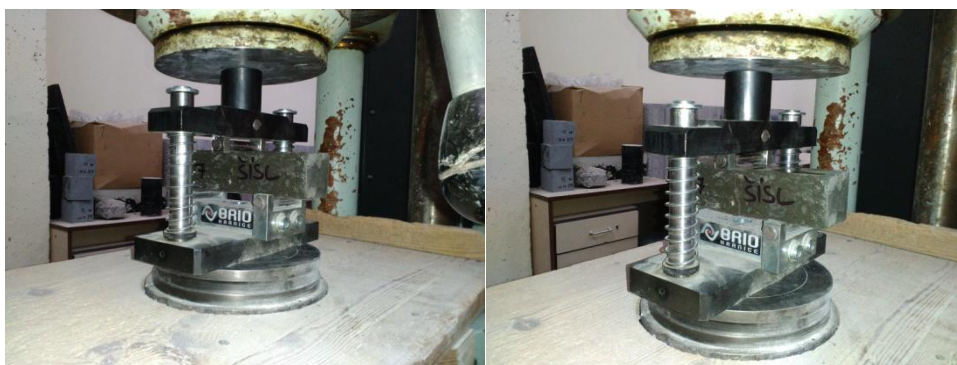
Obr. 31: Zkouška vzorků v tahu za ohybu [37]
