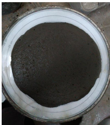
Obr. 27: Rozlití směsi 3 na střešacím stolku za 1 minutu [37]
