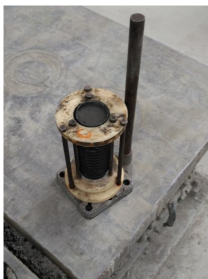
Obr. 42: Vlnovec s cementovým kompozitem na vibračním stole [37]
