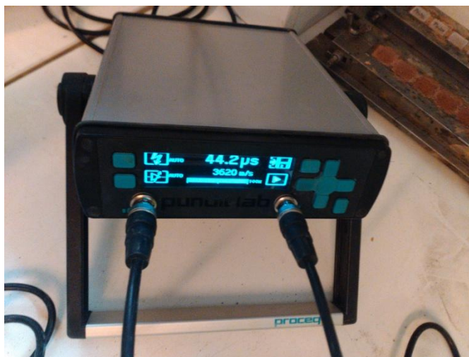
Obr. 39: Výsledek ultrazvukového měření [37]
