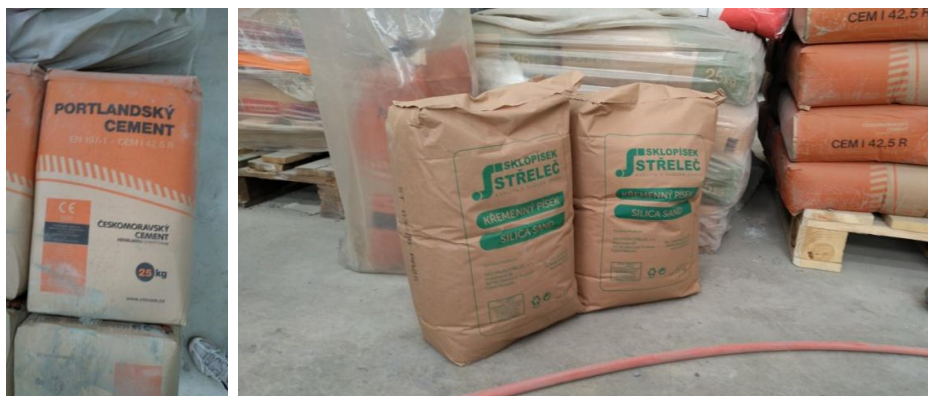
Obr. 20: Použitý cement CEM I 42,5 R a křemičitý písek frakce 0,1 – 0,6 mm a 0,3 – 0,8 mm [37]
