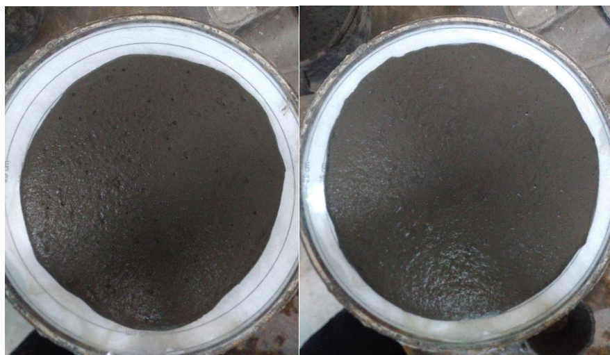
Obr. 26: Rozlité směsi 2 na střešacím stolku za 1 minutu a za 3 minuty [37]
