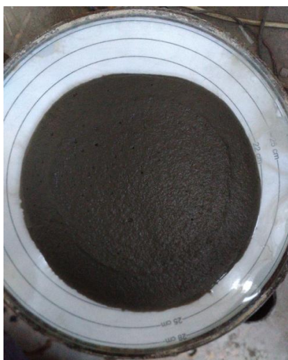
Obr. 28: Rozlití směsi 4 na střešacím stolku za 1 minutu [37]
