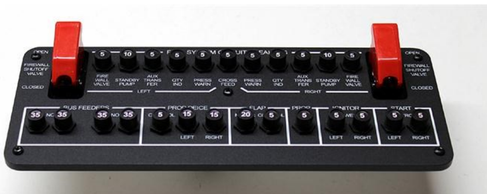
Obrázek 13: Panel jističů palivového systému (zdroj: www.ruscool.co.nz/king_air_b200.html )
