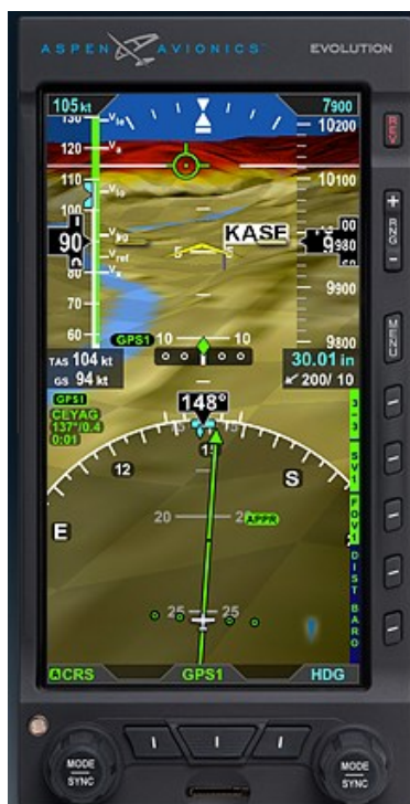
Obrázek 11: Avionika Aspen (zdroj www.aspenavionics.com/products/general-aviation/evolution-1000 )
