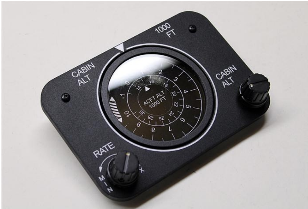
Obrázek 15: Panel nastavení kabinové výšky (zdroj: www.ruscool.co.nz/king_air_b200.html )
