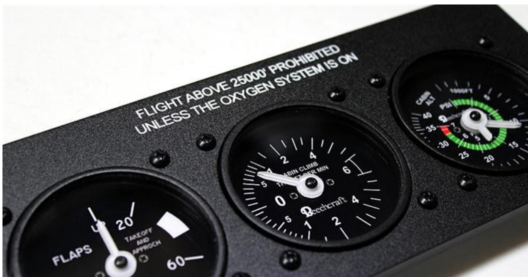
Obrázek 16: Indikátory přetlakování kabiny (zdroj: www.ruscool.co.nz/king_air_b200.html )
