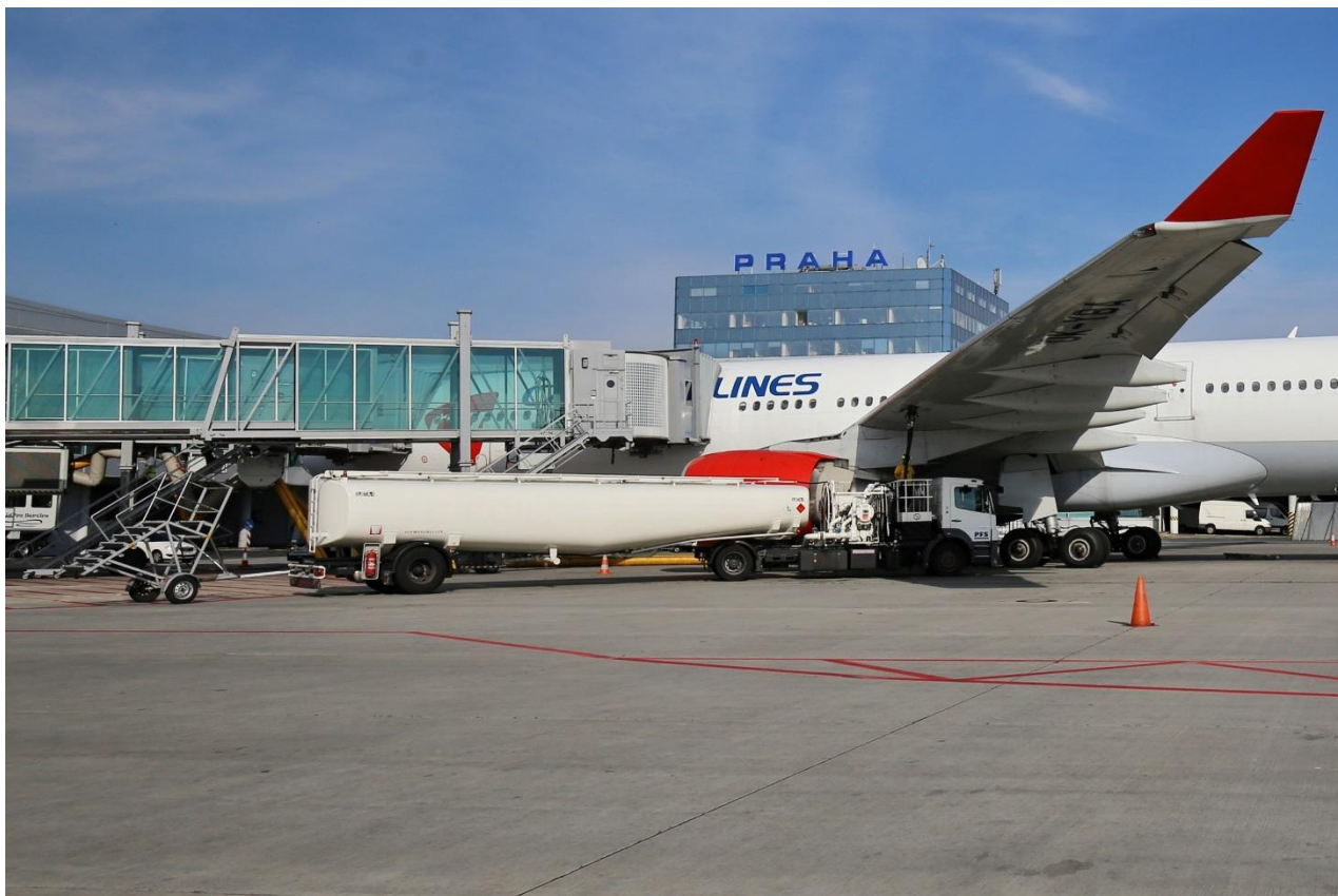
Obrázek 14 – Plnění letadla leteckými pohonnými hmotami na letišti Praha/Ruzyně zdroj: Martin Meluš archiv
