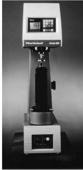
Obrázek 3.6: Zařízení pro zkoušku tvrdosti podle Rockwella [5]
