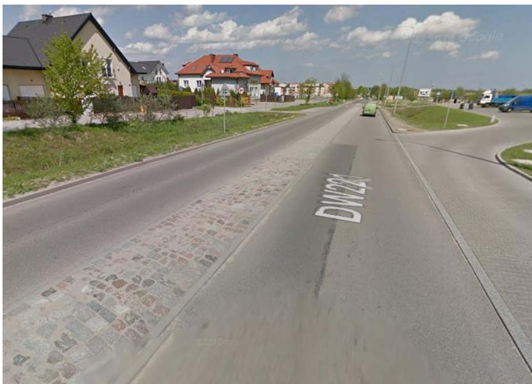
Obr. 80: Ukázka dlážděného středového pásu, v případě potřeby pojižděného. Kowale - Polsko [zdroj: maps.google.com]
