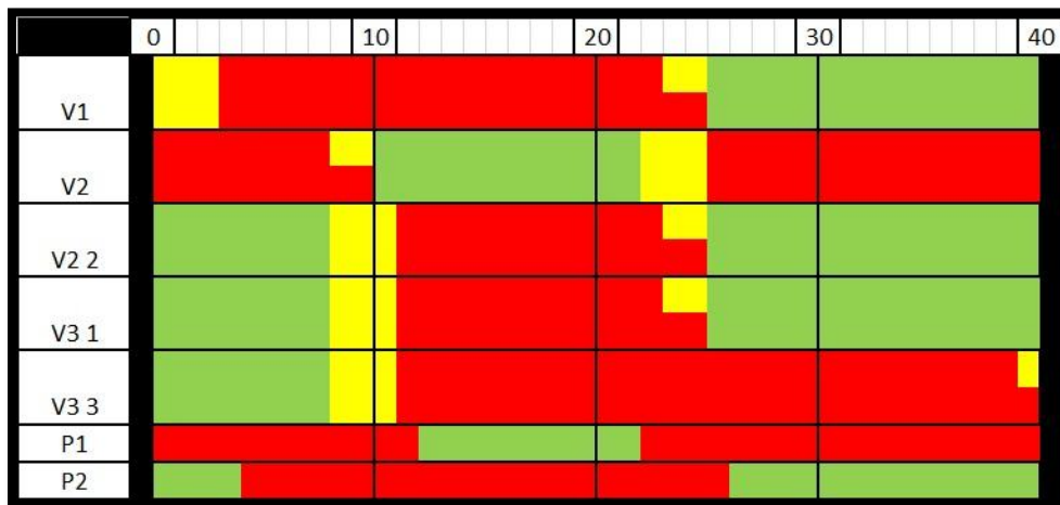
Obrázek 67: Návrh 2 signálního plánu, 3 fáze, délka cyklu 40 sekund
