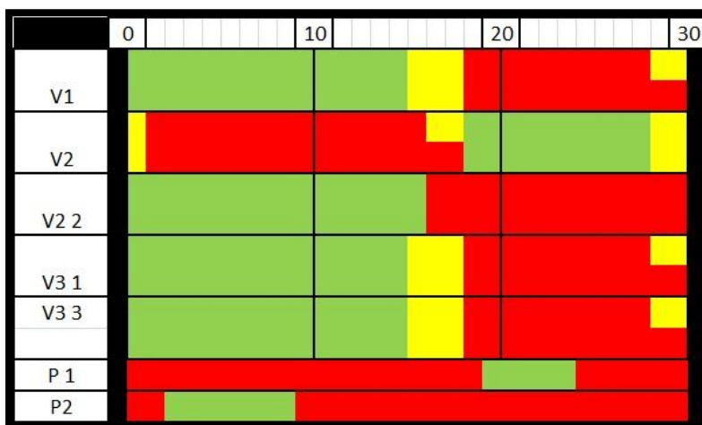
Obrázek 69: Návrh 4 signálního plánu, 2 fáze, délka cyklu 30 sekund
