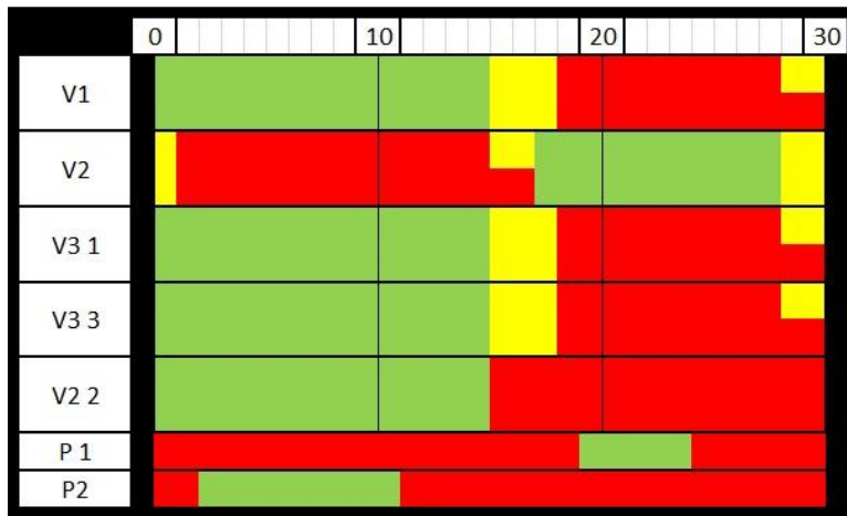
Obrázek 66: Návrh 1 signálního plánu, 2 fáze, délka cyklu 30 sekund
