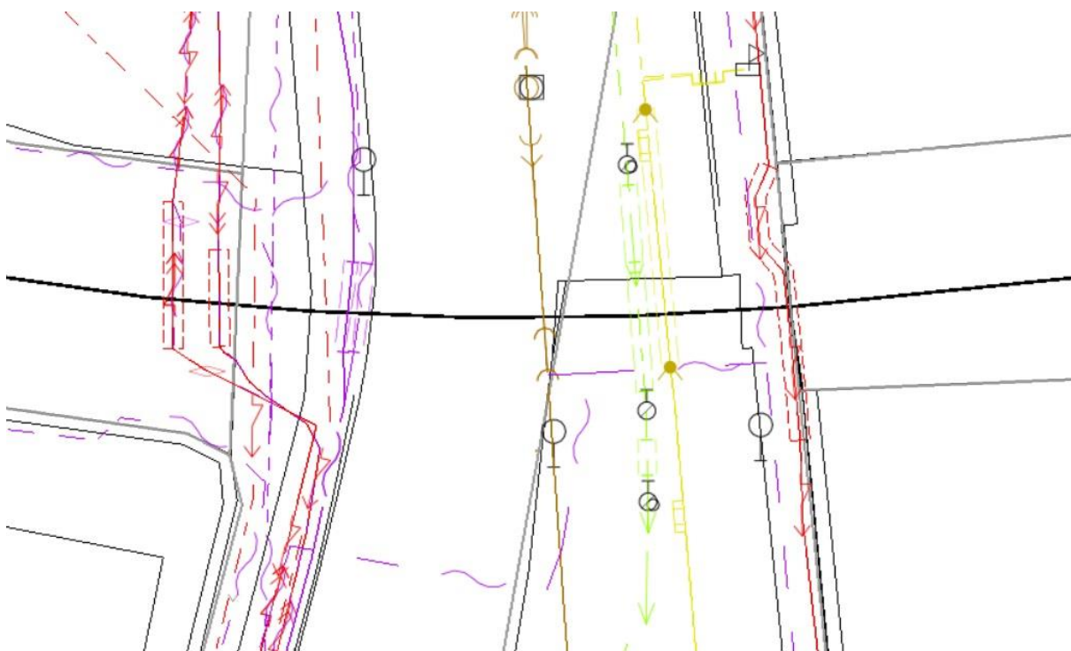
Obrázek 23 – Znázornění inženýrských sítí v místě přejezdu tramvajové trati s ulicí Komořanská ve Variantě 2 - vlečka. Měřítko zobrazení umožnilo vyobrazit chráničky [zdroj: Digitální technická mapa Prahy]
