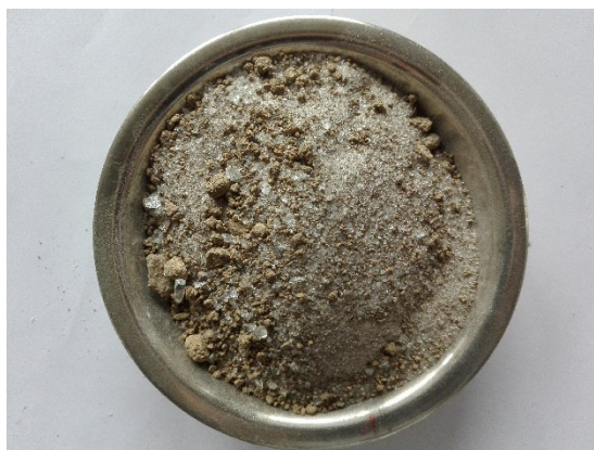
Obr. 6.12 Zemina v kombinaci s amorfním FV panelem 50:50 ve váženice
