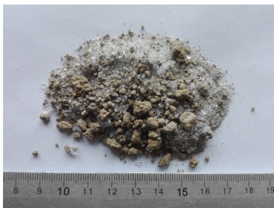
Obr. 6.9 Zemina s polykrystalickým panelem v poměru 50:50 s pravítkem
