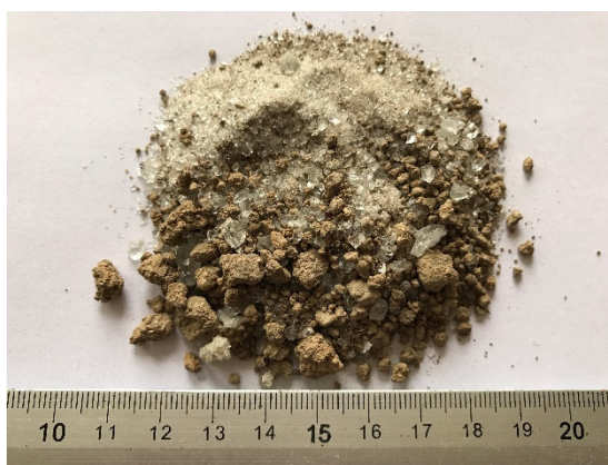
Obr. 6.13 Zemina v kombinaci s amorfním FV panelem 50:50 a měřidlem
