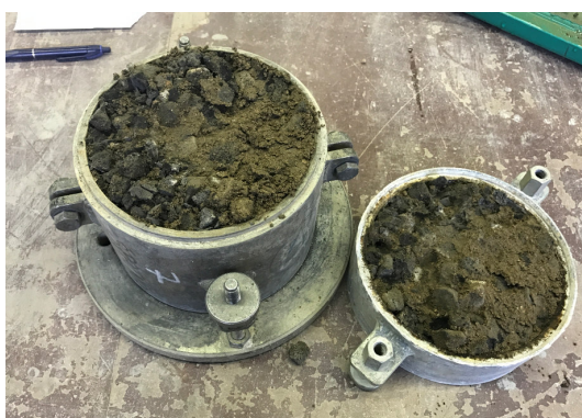
Obr. 6.24 Refaglass-ukázka nemožnosti ideálního seříznutí formy
