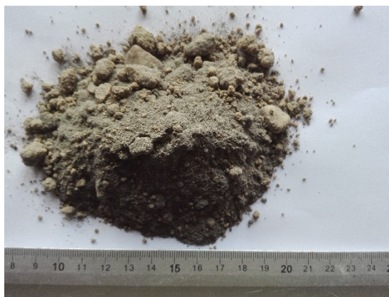
Obr. 6.26 Zemina smíchaná s Refaglass 0/1,6 s měřidlem
