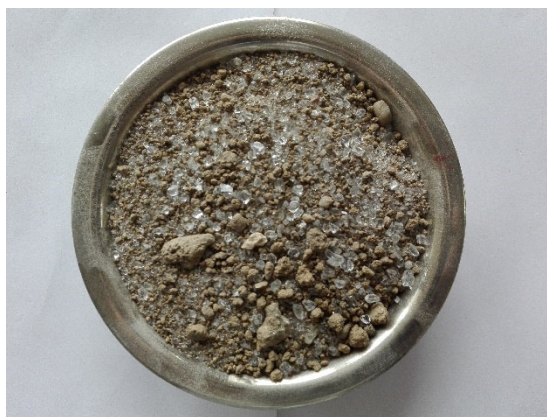
Obr. 6.8 Zemina s polykrystalickým panelem v poměru 50:50 ve váženec
