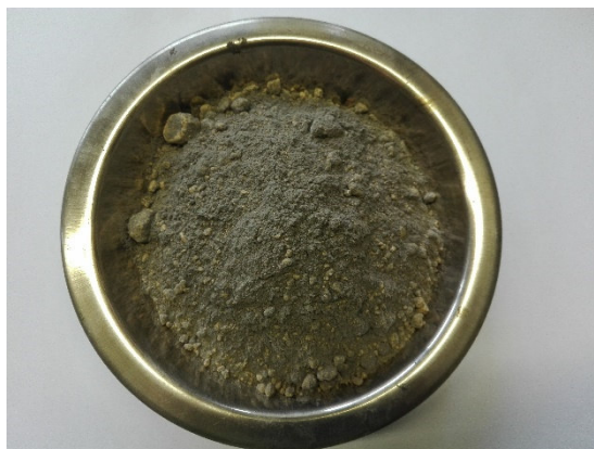
Obr. 6.25 Zemina smíchaná s Refaglass 0/1,6 ve váženec
