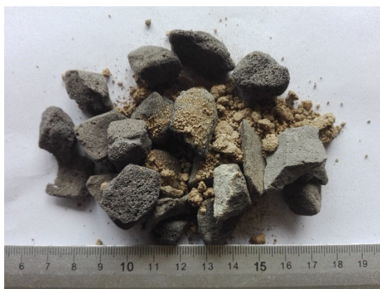
Obr. 6.20 Zemina smíchaná s Refaglass 8/16 s pravítkem
