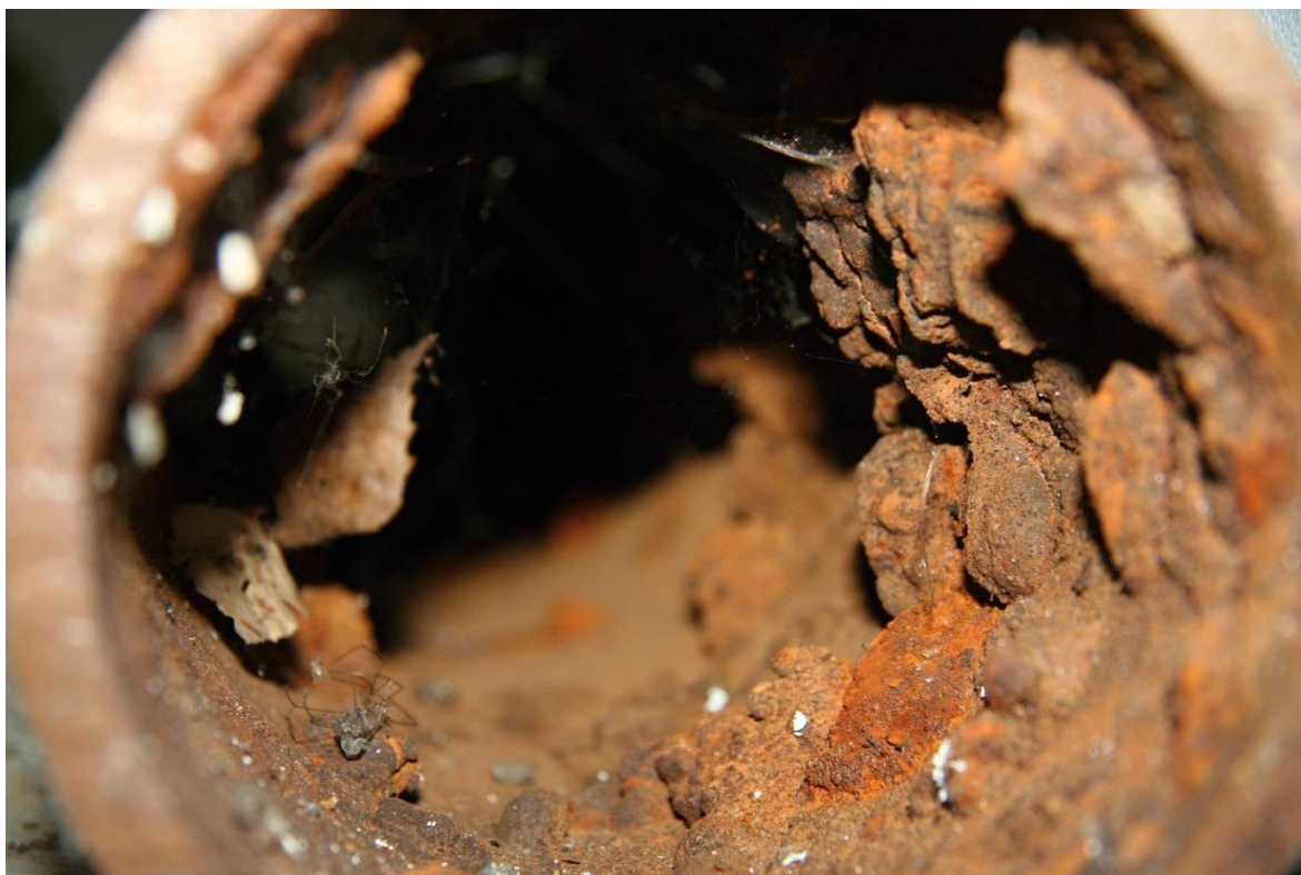
Obrázek 4-4; Řez litinového potrubí z obce Kramolna z roku 1958, jasně patrná inkrustace
