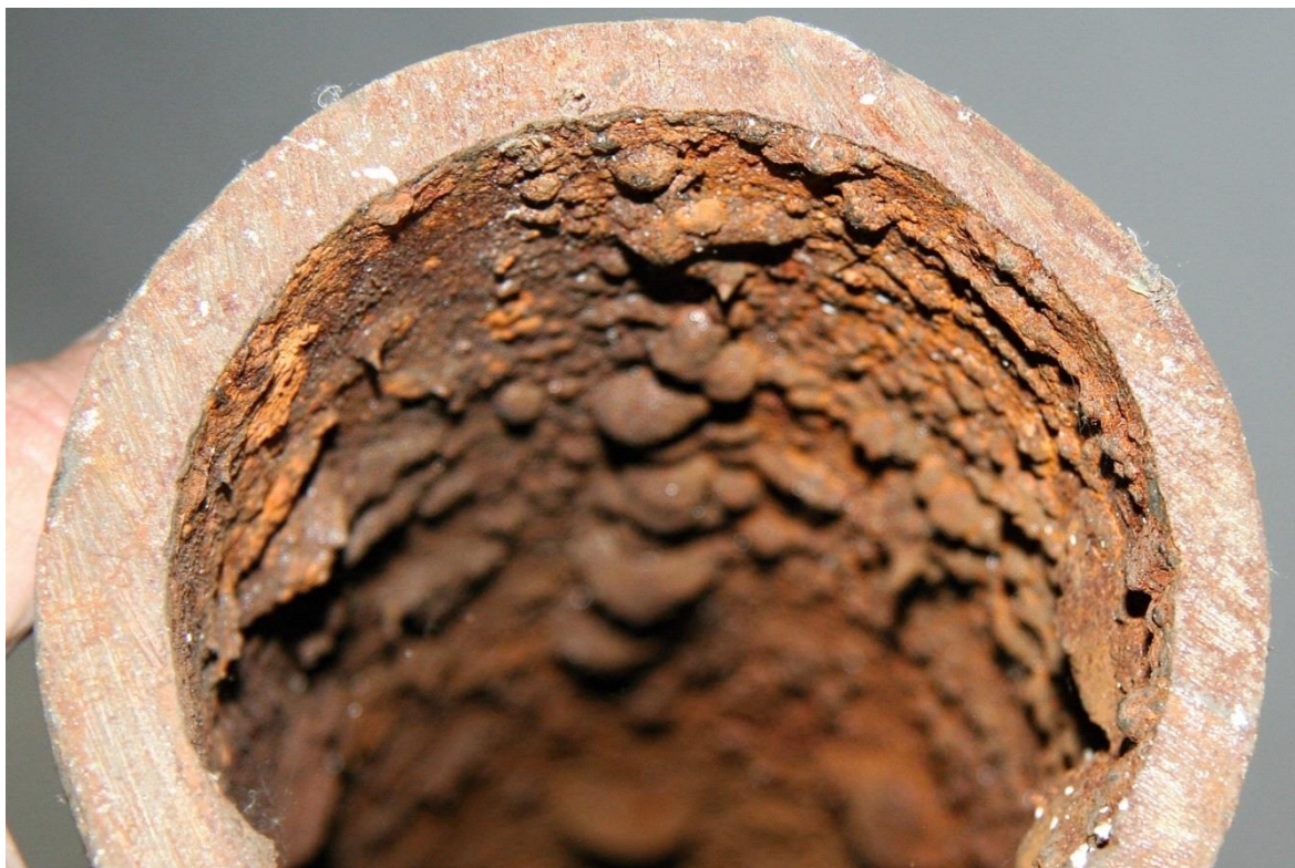
Obrázek 6-1; Litinové potrubí Kramolna DN 100, malé, ale viditelné inkrusty.
