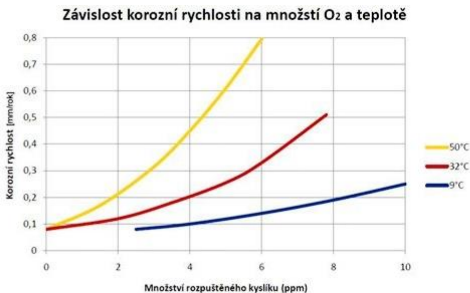
Obrázek 4-2; Vliv rozpuštěného kyslíku ve vodě na korozní rychlost nelegované oceli za různých teplot [24]
