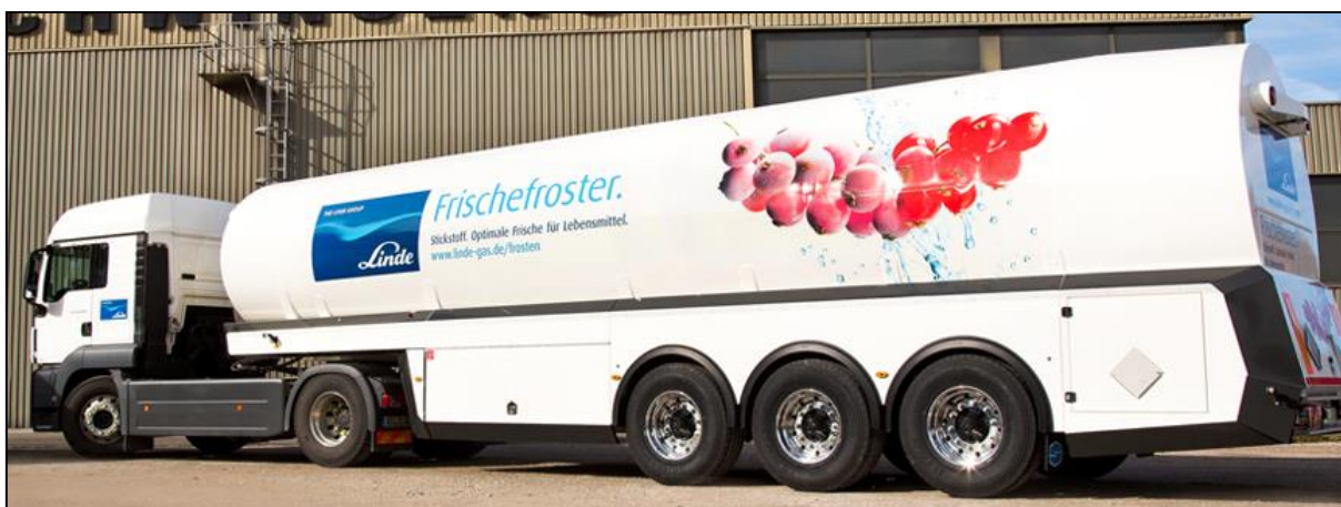
Obrázek 3 Cisternový návěs pro přepravu zkapalněných technických plynů. Provozovatel: Linde; výrobce cisterny: Schwingeschloegel, Rakousko [7]
