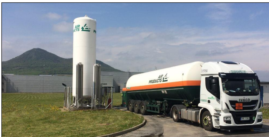
Obrázek 11 Závoz kapalného dusíku cisternovým návěsem společnosti Air Products do statického zásobníku v závodě TRCZ v Lovosicích ze dne 4.5.2017 [zdroj: autor]
