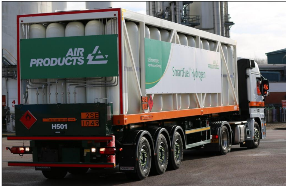
Obrázek 5 Vodíkový návěs s tlakovými lahvemi z kompozitních materiálů společnosti Air Products [zdroj: autor]
