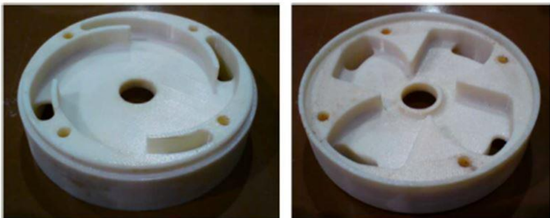
Obrázek 28 - Fotografie vytisknutého difuzoru s dvojitým tvarováním lopatek [13]
