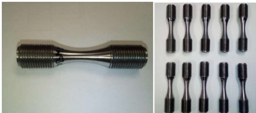
Obr. 34 – Vyrobená zkušební tělesa
