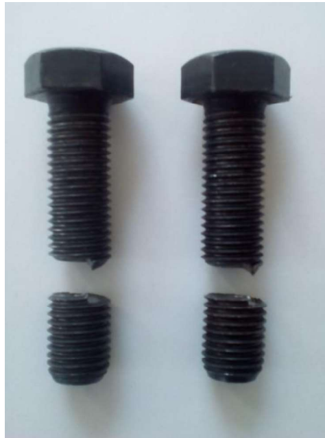
Obr. 56 – Ukázka porušených šroubů
