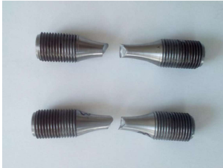
Obr. 36 – Ukázka porušeného zkušební vzorku
