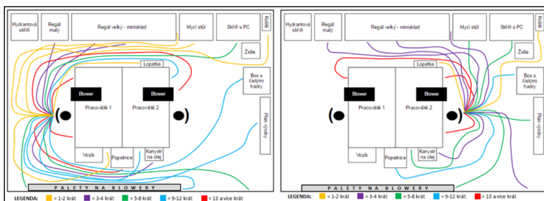
Obrázek 41 Špagetový diagram: P1 (vlevo) a P2 (vpravo) PŘED implementací 5S
