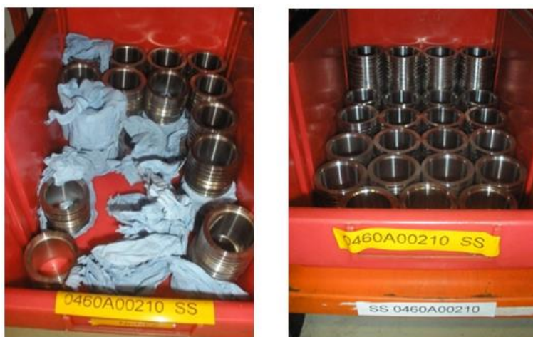
Obrázek 50 Zbytečný obalový materiál PŘED (vlevo) a PO (vpravo) implementaci 5S Zdroj: autorka
