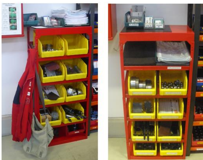
Obrázek 56 Žlutý regál PŘED (vlevo) a PO (vpravo) implementaci 5S Zdroj: autorka
