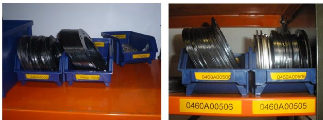
Obrázek 51 Položky na skladu PŘED (vlevo) a PO (vpravo) implementaci 5S Zdroj: autorka
