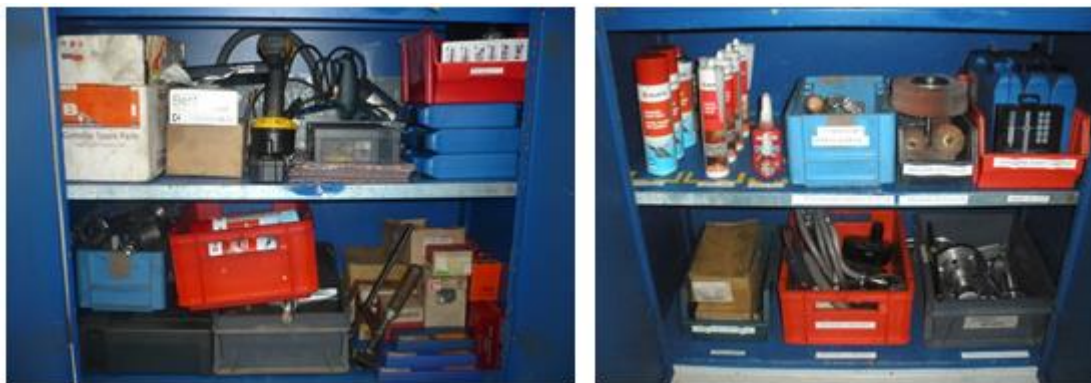
Obrázek 55 Skříně pod PC PŘED (vlevo) a PO (vpravo) implementaci 5S Zdroj: autorka
