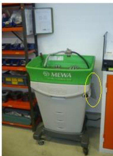
Obrázek 31 Nezřetelně umístěné označení týkající se zacházení s mycím stolem Zdroj: autorka
