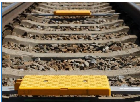
Obrázek 93 - Balízová skupina složená ze dvou eurobalíz, [40]
