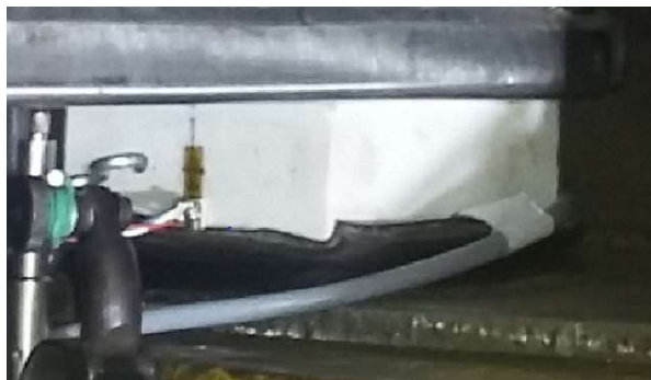
Obr. 83: Zatlačení zedexového bloku do elastomeru při SZS 2, patrná větší deformace než při SZS 1
