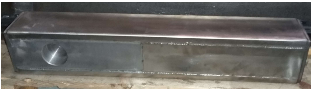
Obr. 32: Ocelová traverza s přivařeným nerezovým plechem
