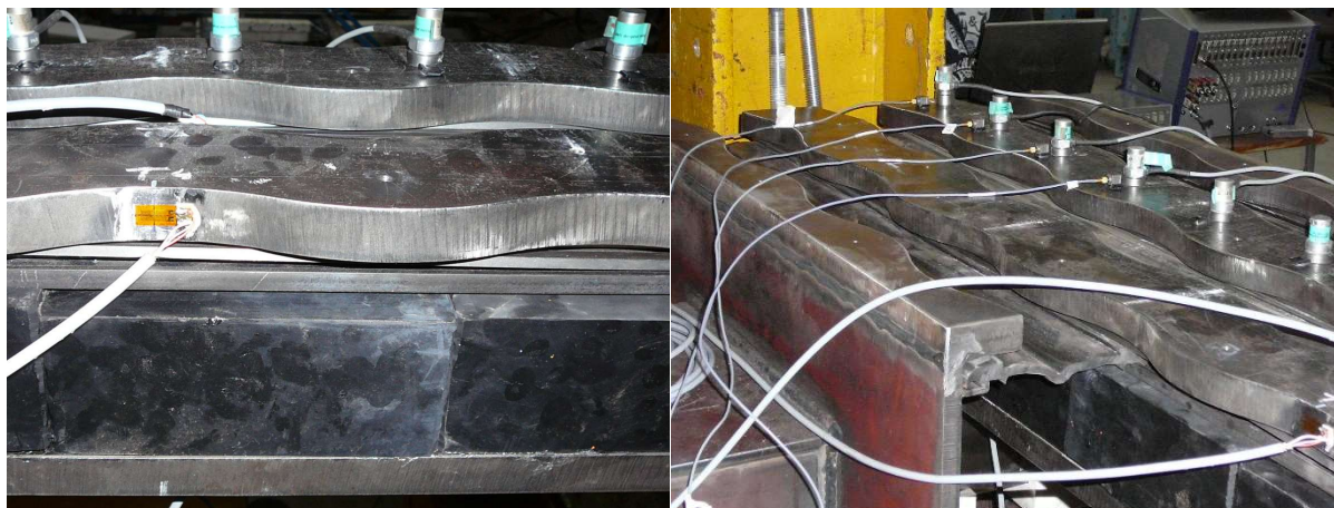
Obr. 63: Nalepené tlumící profily na stojiny lamel
