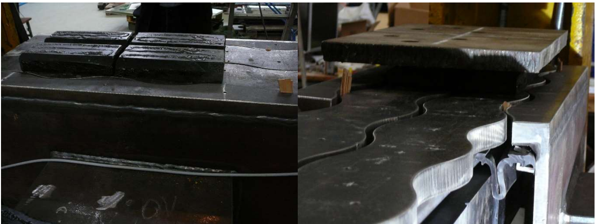
Obr. 87: Vlevo podklady pod zatěžovací deskou, vpravo i s deskou
