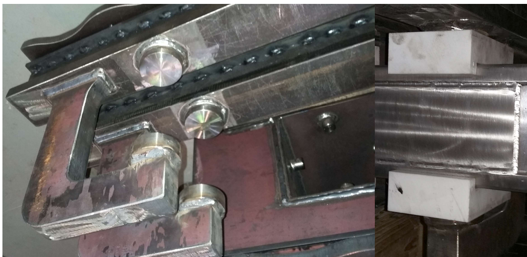
Obr. 33: Vlevo úchyty a nerezové čepy na lamele, vpravo čepy již osazené kluznými bloky a traverzou, horní kluzný blok dotlačen k traverze tíhou lamely
