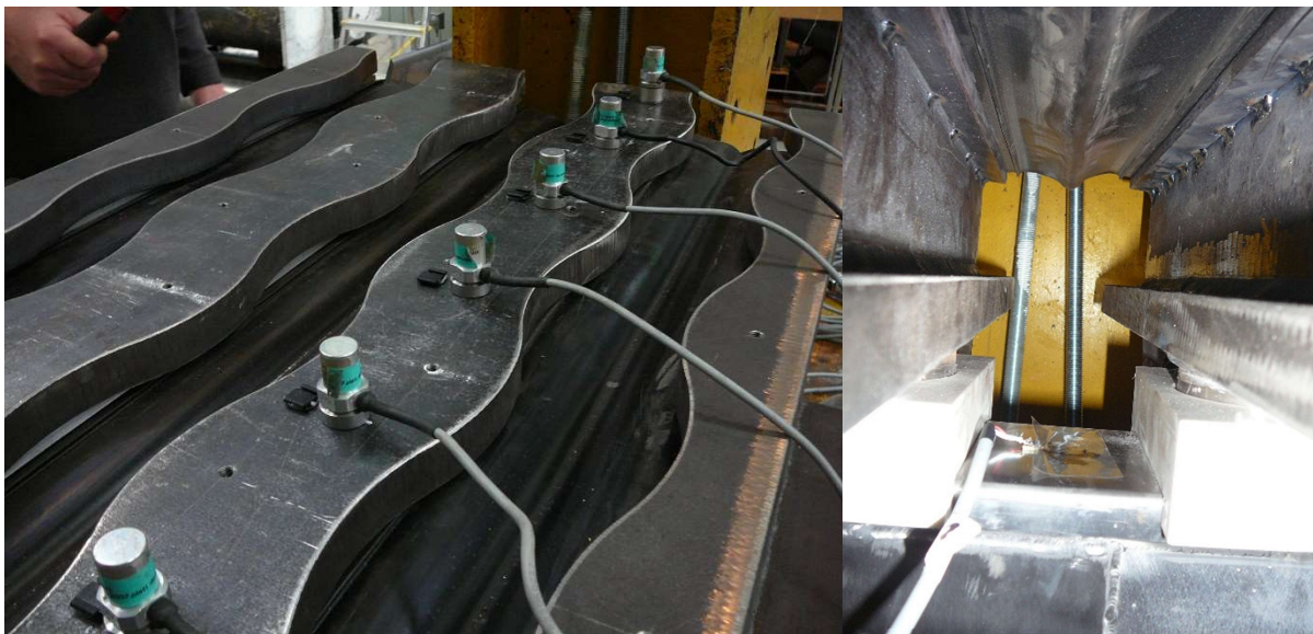
Obr. 60: Maximální rozevření dilatační spáry, vlevo pohled shora, vpravo zespoda
