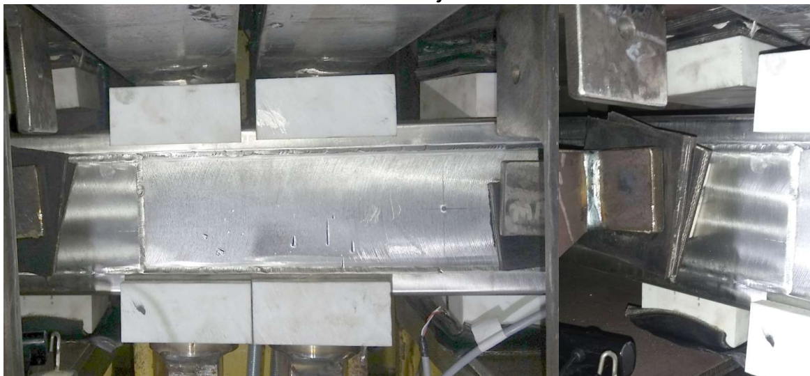
Obr. 95: Vlevo celkový pohled na roznášecí mechanismus při plném zatížení 800 kN, vpravo posuvná krabice – extrémně deformovaný úložný elastomerový blok a velká vůle mezi traverzou a zedexovým blokem
