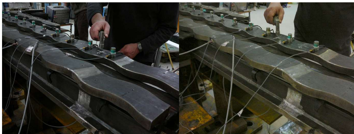
Obr. 62: Vlevo buzení v bodě 1, vpravo v bodě 2
