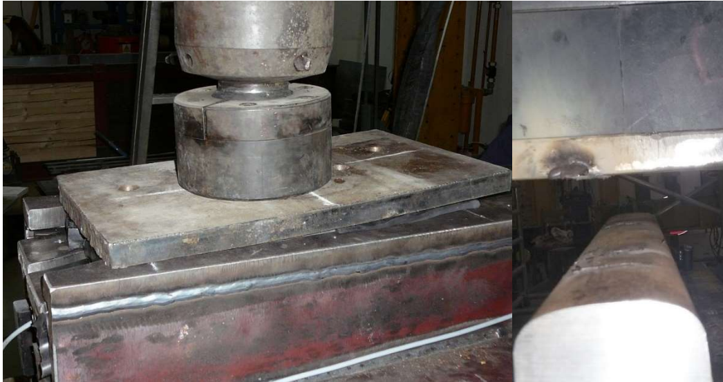
Obr. 94: Vlevo opření zatěžovací desky o krajní profil při síle, vpravo nadzvednutí volného konce ve stejném okamžiku
