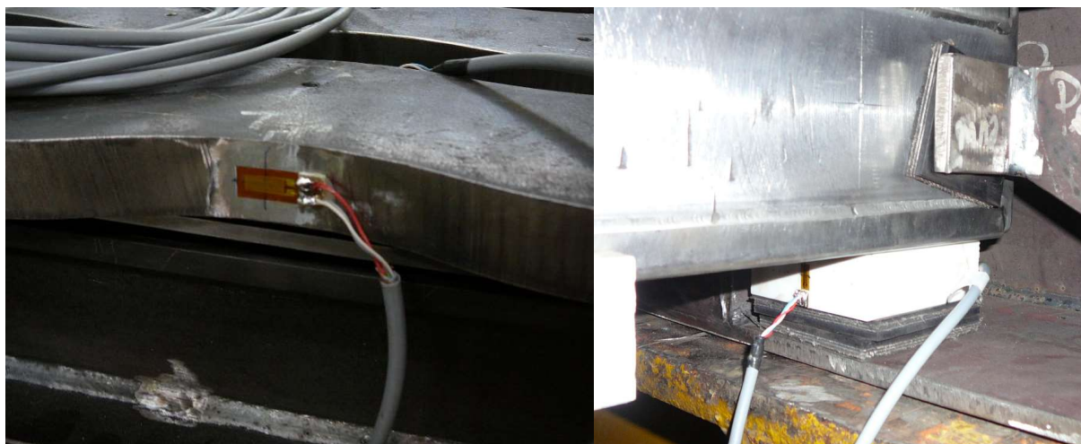
Obr. 78: Vlevo umístění T4, vpravo T5 (viditelný vpředu) a T6 (skrytý vzadu)
