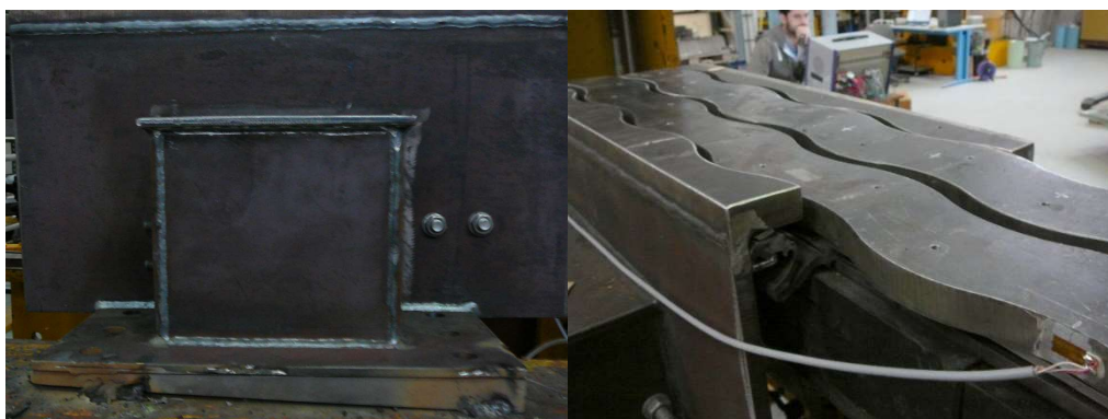
Obr. 89: Vlevo klínová deska pod pevnou krabicí, vpravo horní povrch, viditelný výškový rozdíl kvůli klínovým deskám
