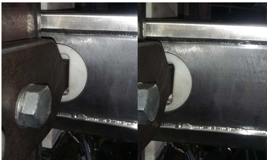
Obr. 84: Vlevo poloha zádržného plechu v zedexovém čepu bez zatížení, vpravo se zatížením, viditelný významný rozdíl
