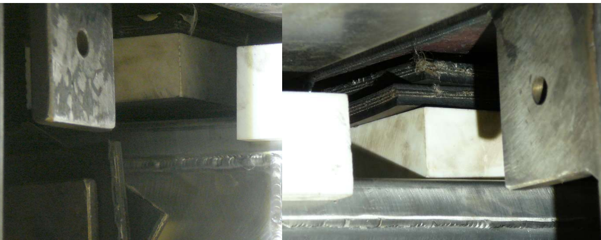
Obr. 88: Vlevo nárůst vůle mezi traverzou a zedexovým blokem v posuvné krabici při zatížení, vpravo nárůst vůle mezi pevnou krabicí a elastomerovým blokem.
