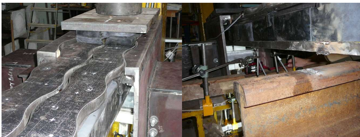
Obr. 92: Vlevo podložená zatěžovací deska, vpravo nadzvednutý volný konec lamely při síle 400 kN
