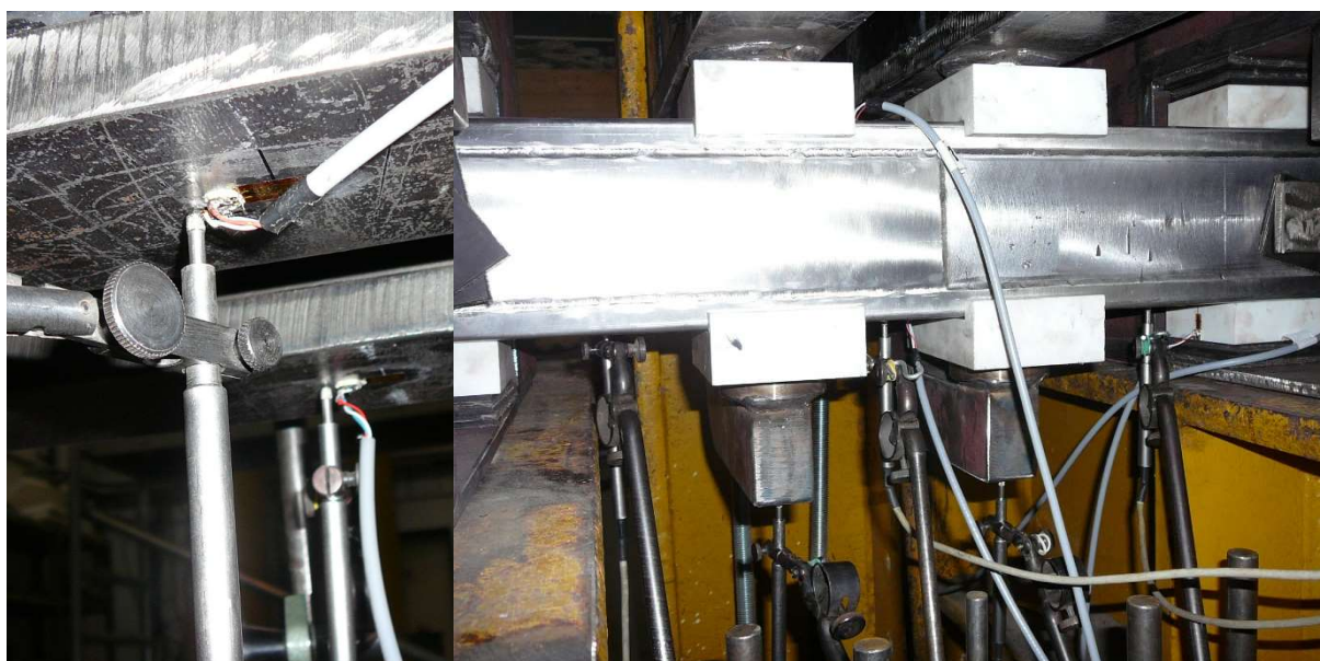
Obr. 80: Vlevo snímače U1 a U2 v těsné blízkosti tenzometrů T1 a T2, vpravo umístění snímačů dráhy na roznášecím mechanismu - zleva U6, U4, U7, U3 a U5
