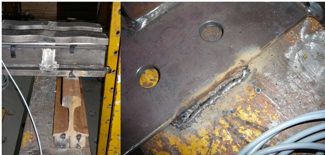
Obr. 61: Vlevo podepření volného konce lamely, vpravo upevnění krabice
