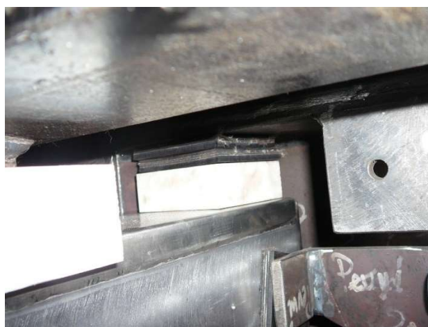
Obr. 38: Detail uložení na horním povrchu traverzy, patrná vůle mezi elastomerovým blokem a krabicí (bloky nejsou přilepeny ke krabici)
