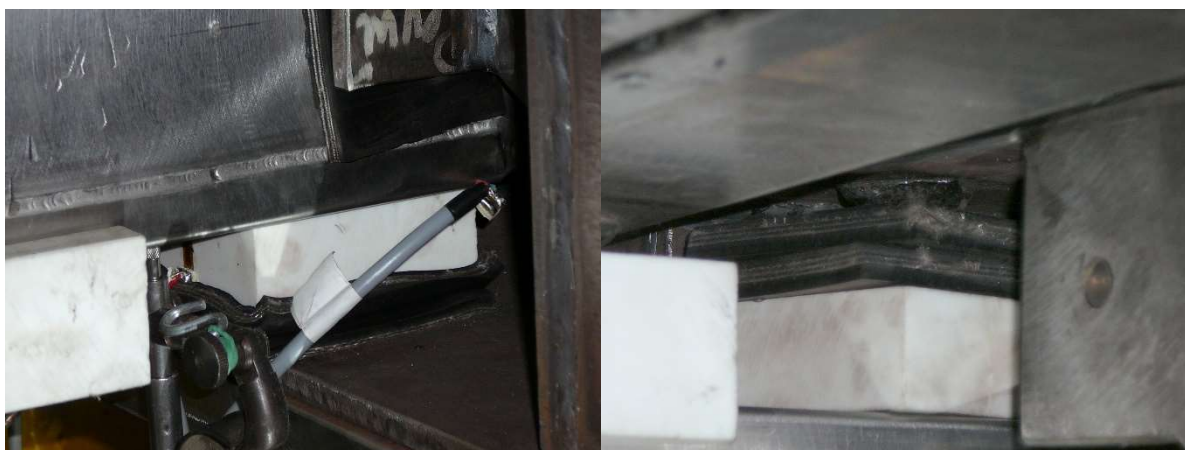
Obr. 93: Vlevo deformovaný elastomerový blok v pevné krabici při síle 400 kN, vpravo nárůst vůle mezi krabicí a elastomerem při stejné síle
