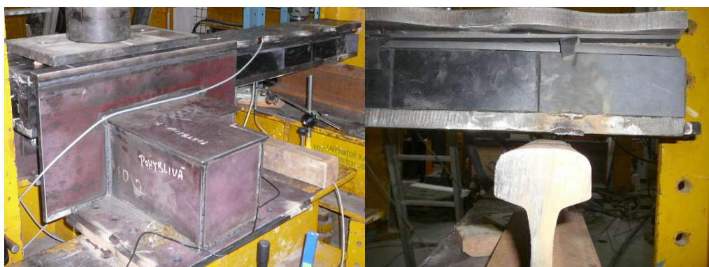
Obr. 90: Vlevo klínová deska pod posuvnou krabicí, vpravo nadzvednutý volný konec
