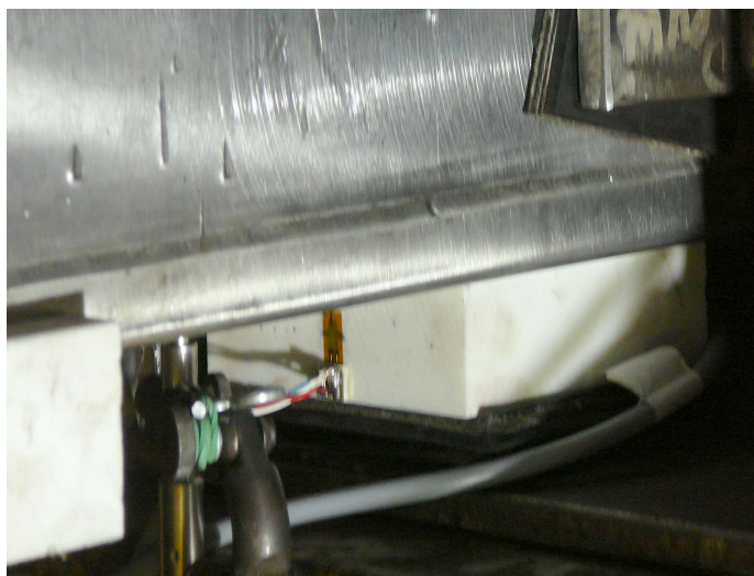
Obr. 82: Zatlačení zedexového bloku do elastomeru při SZS 1
