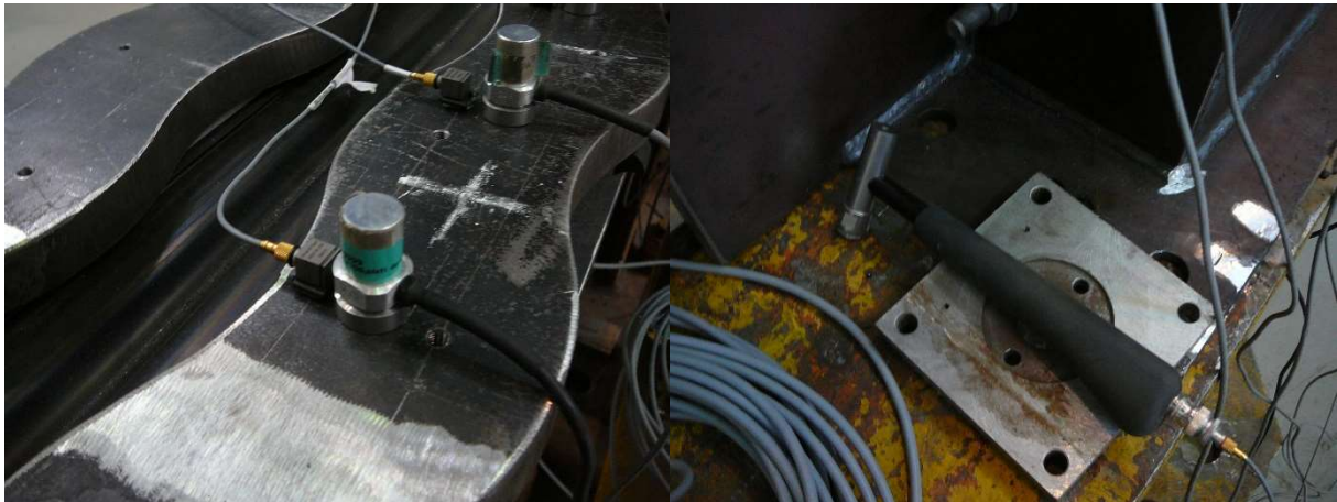
Obr. 59: Vlevo současné umístění snímačů EC a K132, vpravo modální kladívko
