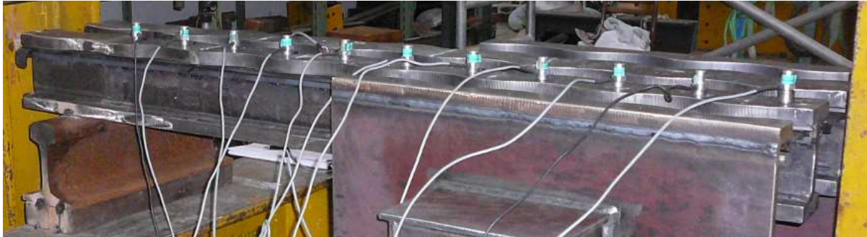
Obr. 58: Umístění 11 snímačů Experimentálního centra
