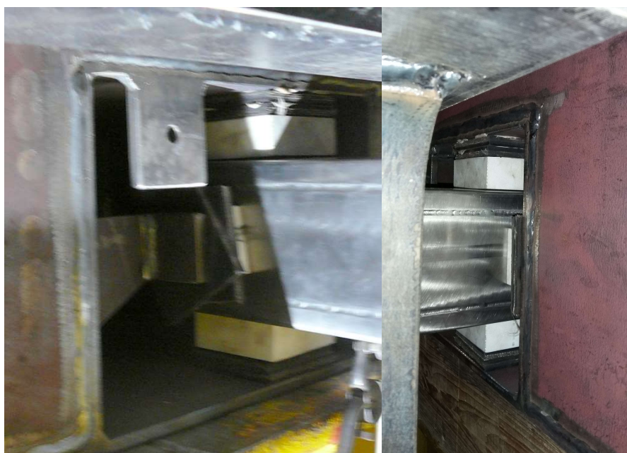
Obr. 42: Kluzné uložení tentokrát i po stranách traverzy, vlevo patrná vůle mezi horním povrchem traverzy a kluzným blokem (kluzný a úložný blok jsou přilepeny ke krabici)
