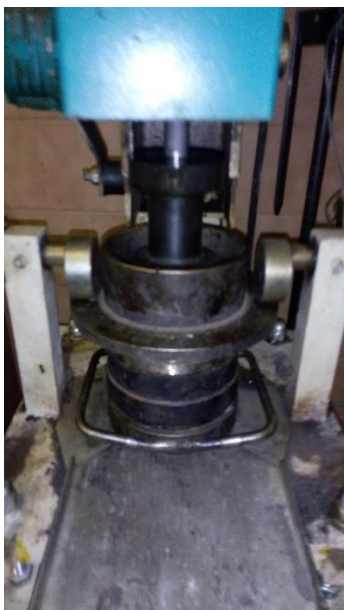
Obr. č.38: Hutnění tělesa
