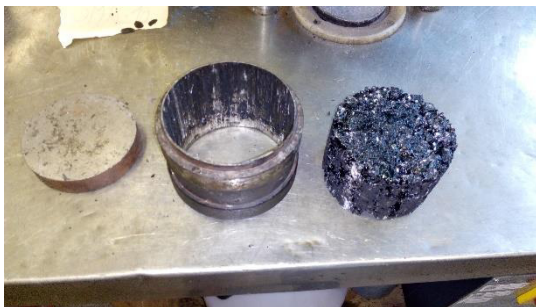
Obr. č.40: Podstavec, forma, Marshallovo těleso
