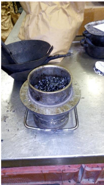
Obr. č.36: Forma na Marshallovo těleso před hutněním
