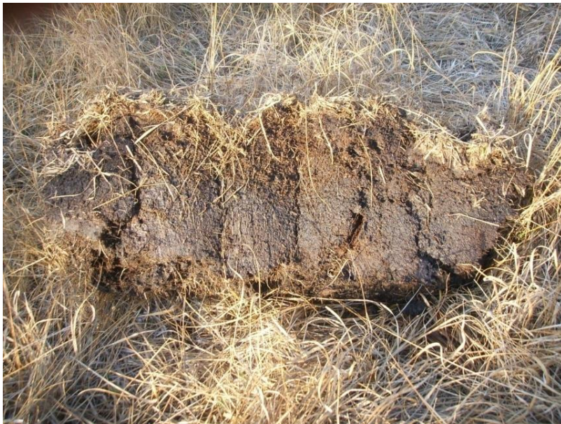
Obrázek 13-3 - Půdní vzorek použitý pro laboratorní kalibraci vlhkostních čidel (foto M. Šanda)
