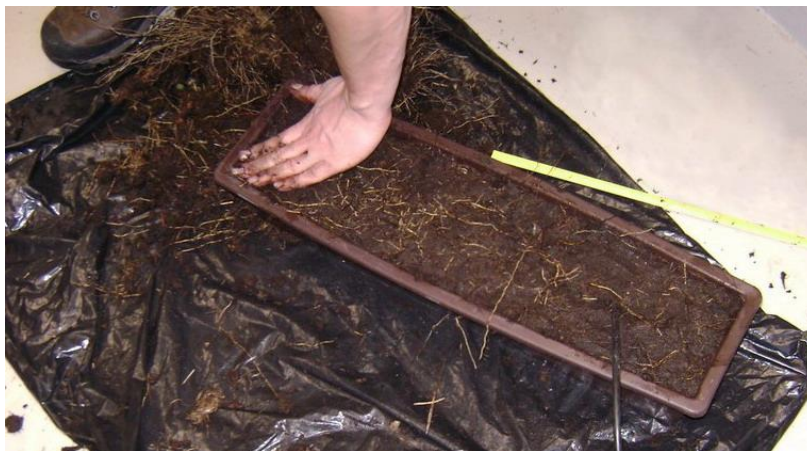
Obrázek 13-6 - Manuální hutnění vzorku pro kalibraci vlhkostního čidla [9]
