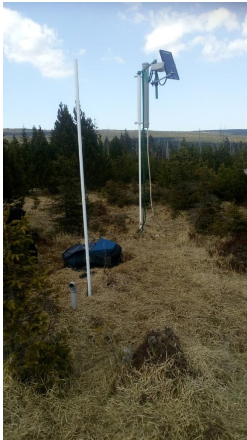
Obrázek 13-14 – Ruční sněhoměrný kolektor, solární napájení dataloggeru Campbell CR1000
