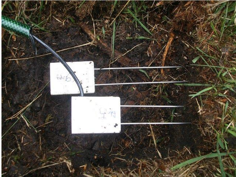
Obrázek 13-10 - Vlhkostní čidla CS616 instalované v hloubce 5 cm a 10 cm (foto M. Šanda)
