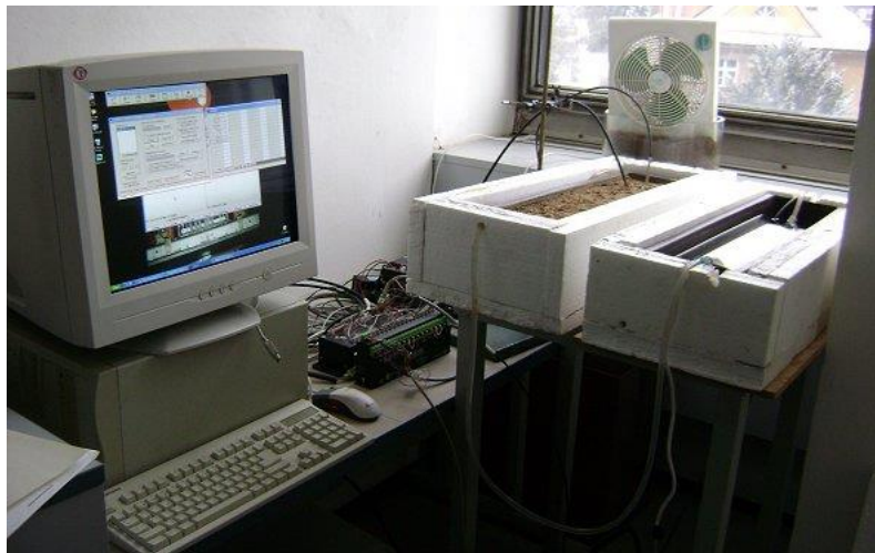
Obrázek 13-8 - Zapojená soustava zařízení pro kalibraci vlhkostního čidla [9]
