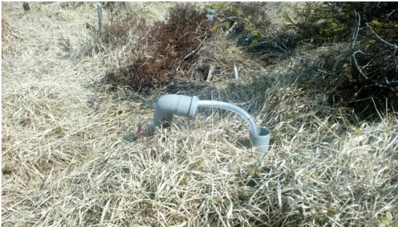
Obrázek 13-11 - Hladinové čidlo (DV) monitorující průběh hladiny podzemní vody
