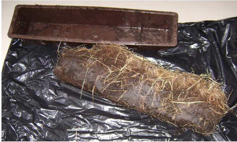
Obrázek 13-4 - Odebraný vzorek pro kalibraci vlhkostního čidla [9]
