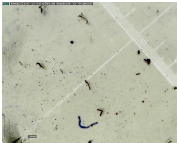
Obr. 40 50x zvětšená vlákna Arbocelu
