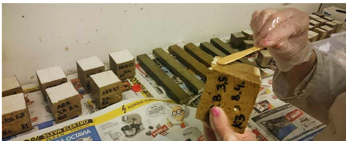
Obr. 30 Izolování vzorků epoxidovou pryskyřicí
