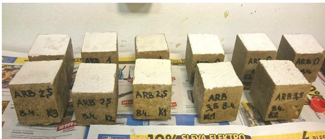
Obr. 27 Připravené vzorky pro měření absorpčního koeficientu – krychle o straně 70 mm
