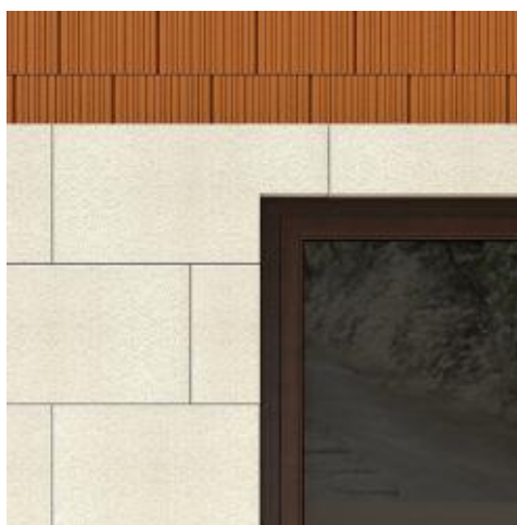
Obr. 34: Spáry v místě nadpraží oken. otvoru [19]
