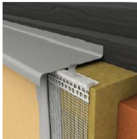
Obr. 41: Ukončovací lišta v místě parapetu [19]
