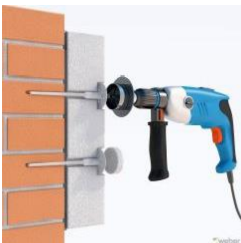
Obr. 35: Postup kotvení zapuštěné talířové kotvy [19]
