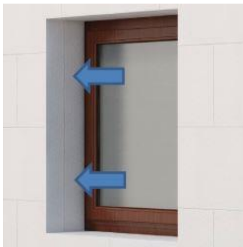
Obr. 32: Izolace ostění u výplně otvoru [19]
