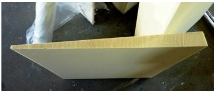
Obr. 2 – Klínová deska pro izolaci tepelného mostu [5]
