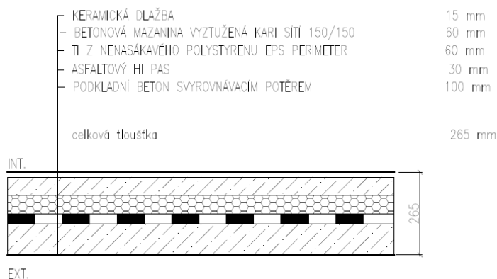
Obr. 2-7 Skladba podlahy – PDL 1
