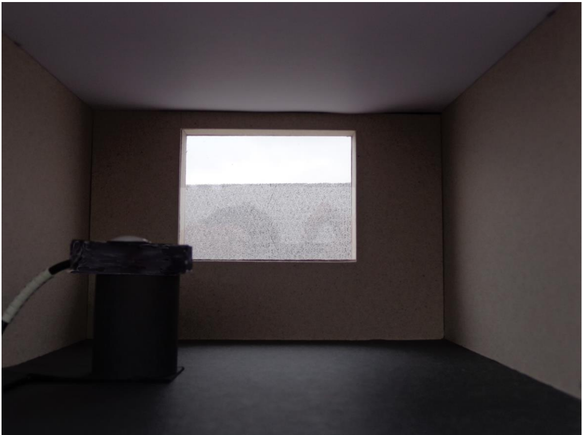
Obrázek č. 19 – pohled na čidlo jasoměru umístěné v místnosti s vnějším stíněním ( \varepsilon = 15^\circ )
