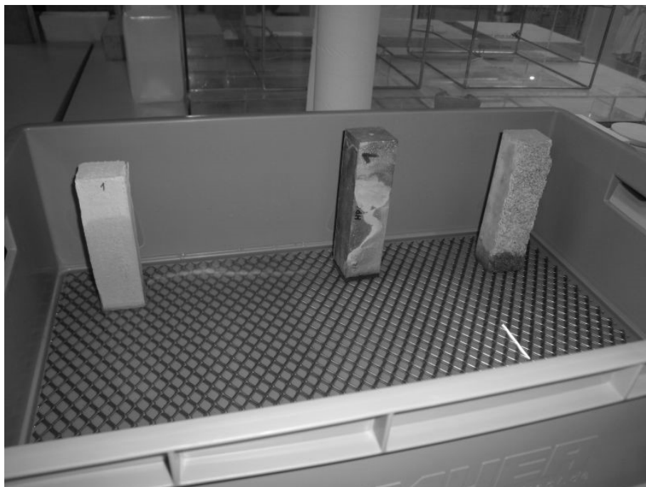
Obrázek 31: Zkouška kapilární vztlínavosti
