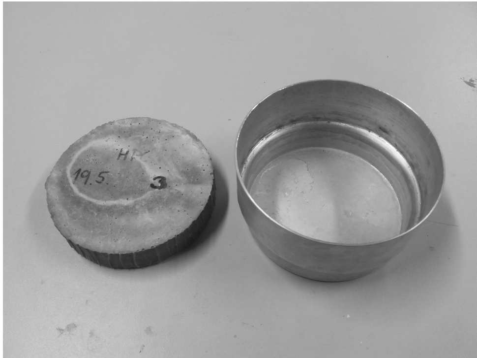
Obrázek 21: Vzorek a miska na zkoušku faktoru difuzního odporu
