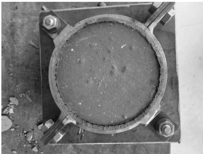
Obrázek 11: Forma na vzorek pro zkoušku difuzního odporu
