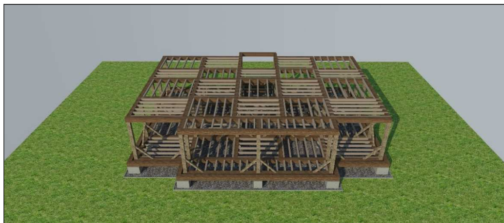
Obr. 9 Vyztužení patra šachovnicově uloženými trámkami
