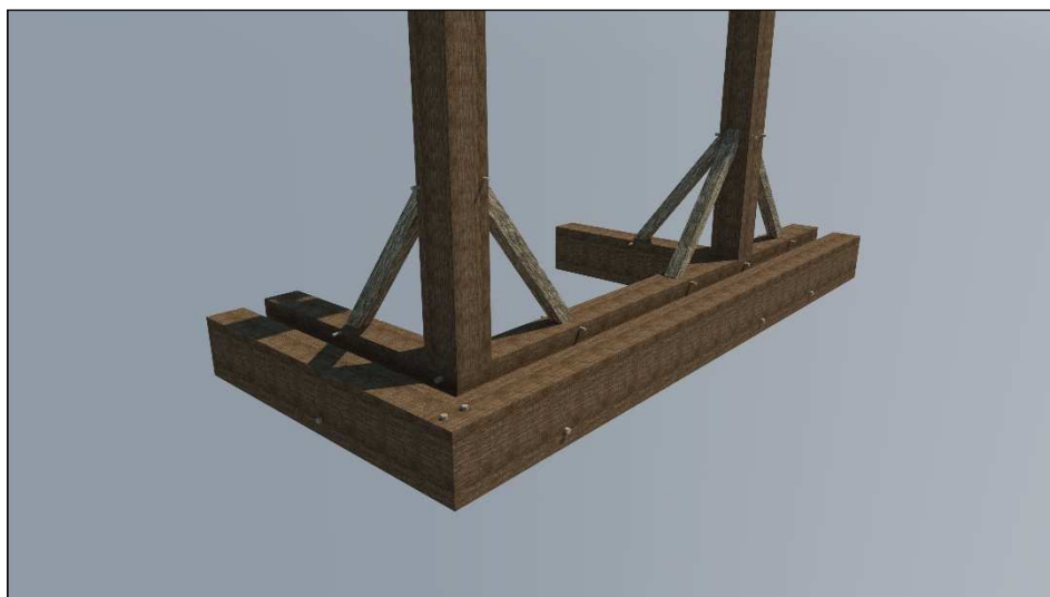
Obr. 35 Složená nosná konstrukce u založení stavby
