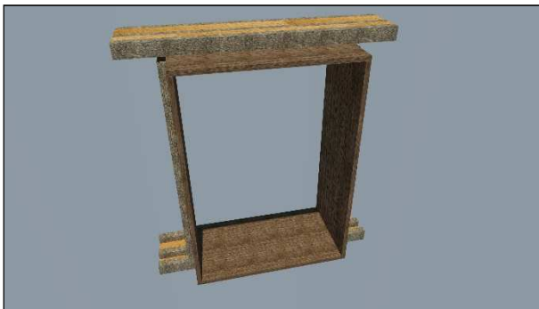
Obr. 58 Výplň mezer dřevovláknitou izolací mezi hranoly
