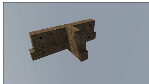
Obr. 27 Nárožní – středové fošny pro spoj nosných trámů (2-3.NP)
