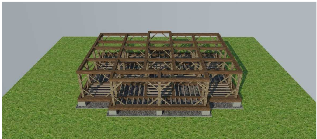
Obr. 8 Doplnění nosného roštu 2.NP a pásků
