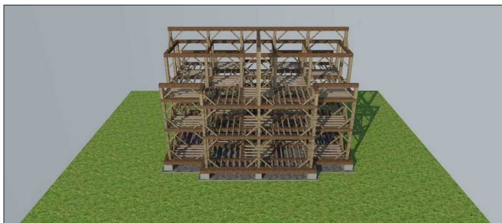
Obr. 15 Doplnění střešní konstrukce o sloupy nesoucí vaznici
