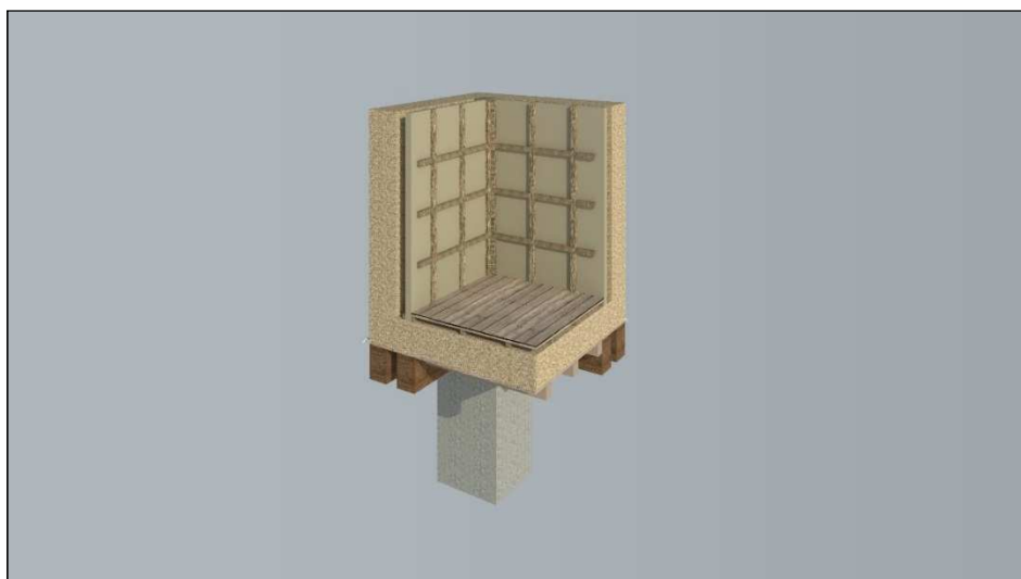
Obr. 49 Konstrukce doplněná dřevovláknitou izolací a dřevěná podlaha
