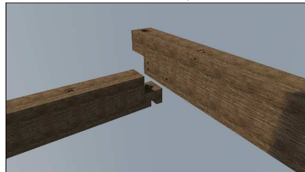
Obr. 20 Nárožní spoj nosného trámu nesoucí dřevěnou konstrukci
