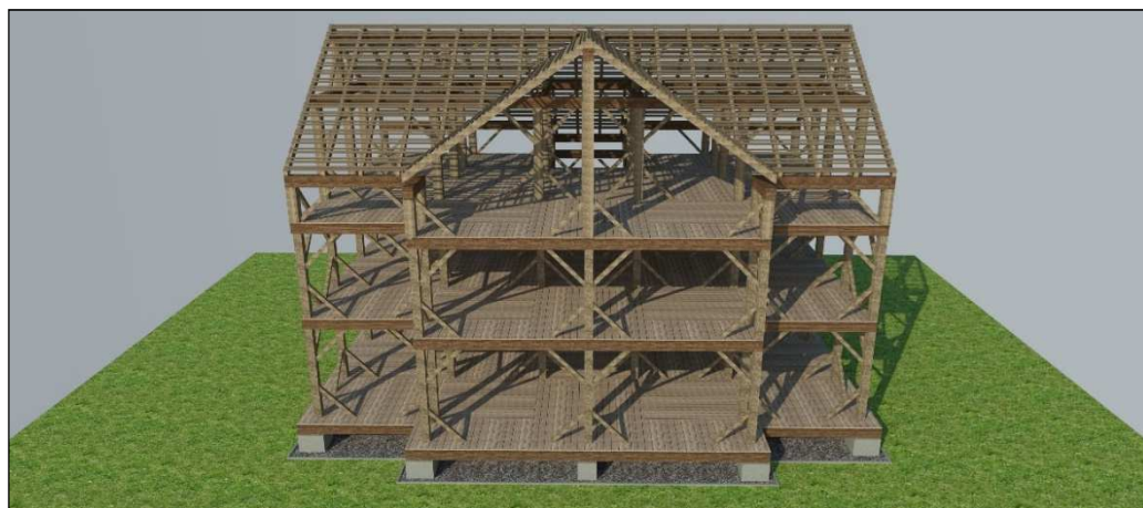
Obr. 39 Prkenné záklopy jednotlivých podlaží
