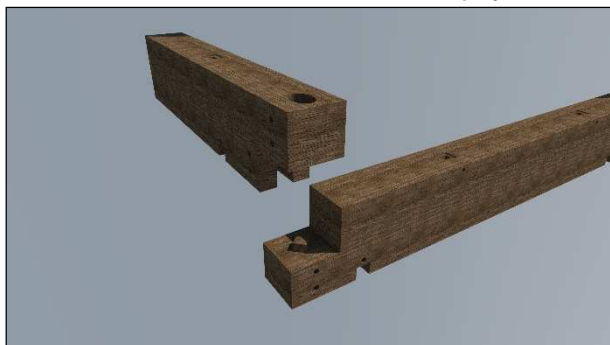
Obr. 20 Nárožní spoj nosného trámu nesoucí dřevěnou konstrukci
