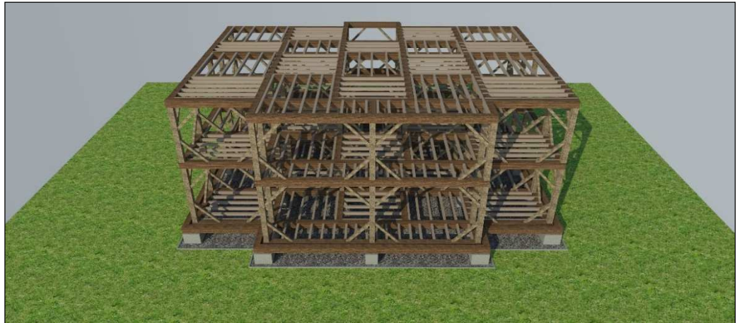
Obr. 12 Vyztužení patra šachovnicově uloženými trávky
