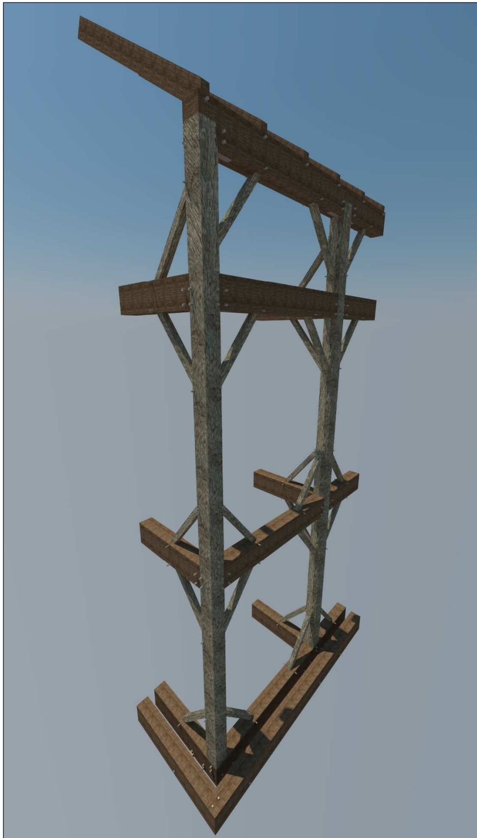
Obr. 38 Schéma nosné dřevěné konstrukce
