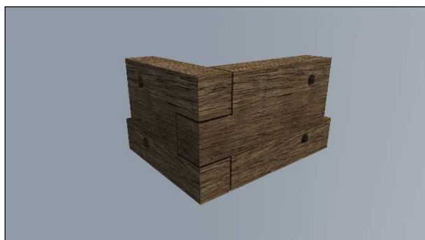
Obr. 27 Nárožní – středové fošny pro spoj nosných trámů (2-3.NP)
