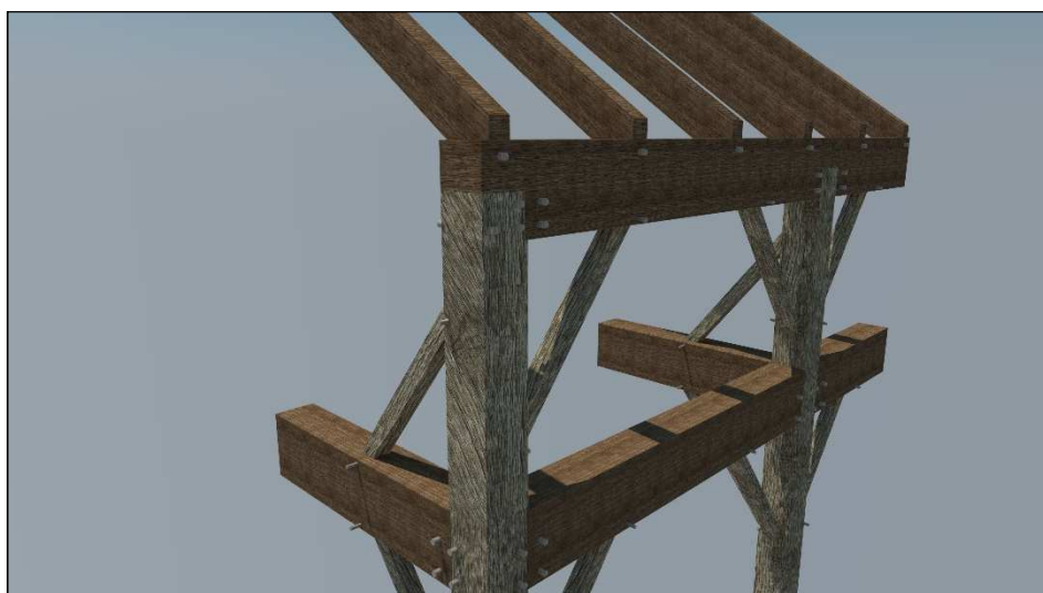
Obr. 37 Složená nosná konstrukce (pozednice, osazení krokví)
