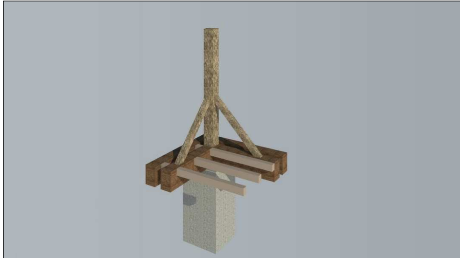
Obr. 43 Nosná dřevěná konstrukce na betonových patkách
