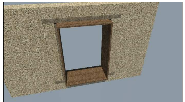
Obr. 58 Výplň mezer dřevovláknitou izolací mezi hranoly
