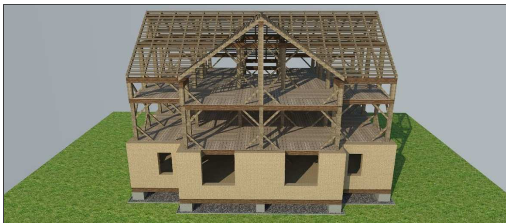
Obr. 41 Obvodové slaměné balíky
