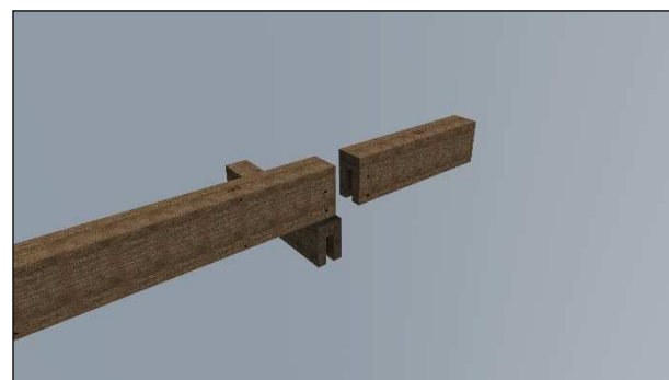
Obr. 25 Čela středových nosných trámů 1-2.NP
