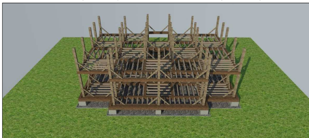
Obr. 10 Osazení sloupů 2.NP a pásku v dolní části
