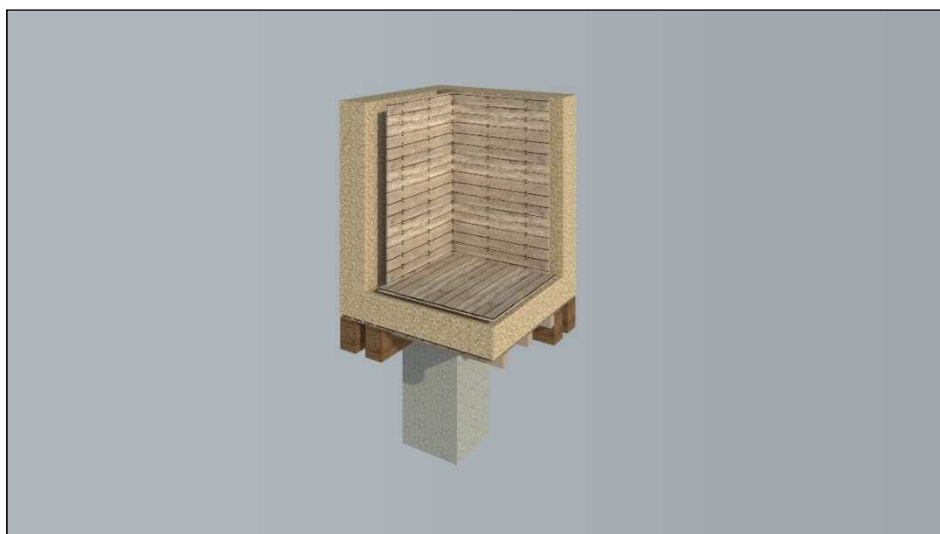
Obr. 50 Prkenný záklop na stěně
