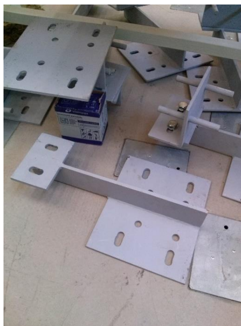
Obrázek 56: Prototyp kotev. Na fasádu budou upevněny v úrovni věnců (vpravo) a při instalaci panelů přišroubovány úhelníky s trny zapadajícími do předem připravených otvorů v panelech [36].
