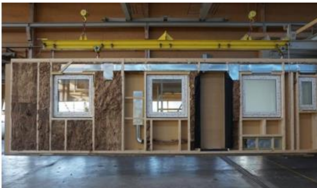
Obrázek 44: Výroba prefabrikovaných panelů včetně integrace potrubí nuceného větrání [31].
