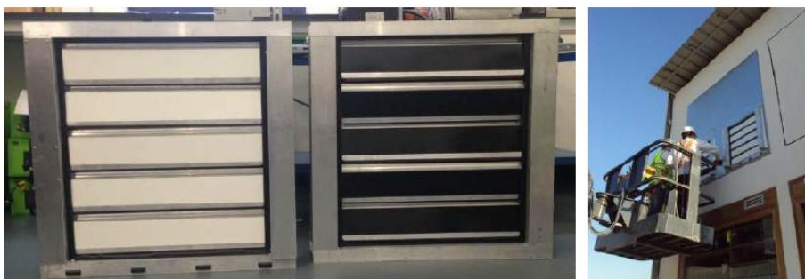
Obrázek 8: Testování prototypu jednotky pasivní solární ochrany a energetické absorpce [10].
