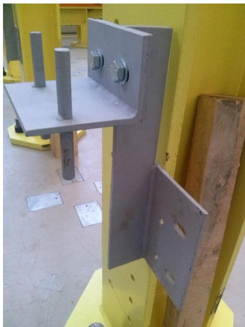
Obrázek 56: Prototyp kotev. Na fasádu budou upevněny v úrovni věnců (vpravo) a při instalaci panelů přišroubovány úhelníky s trny zapadajícími do předem připravených otvorů v panelech [36].
