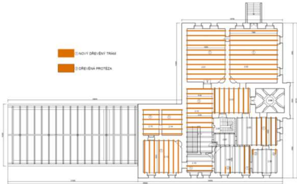
Obrázek 79 - Schéma sanace dřevěných trámů stropní konstrukce 1NP
