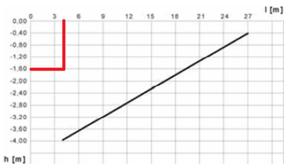
Obr. 9.2.8a Graf sací části čerpadla automatické tlakové stanice [12]
