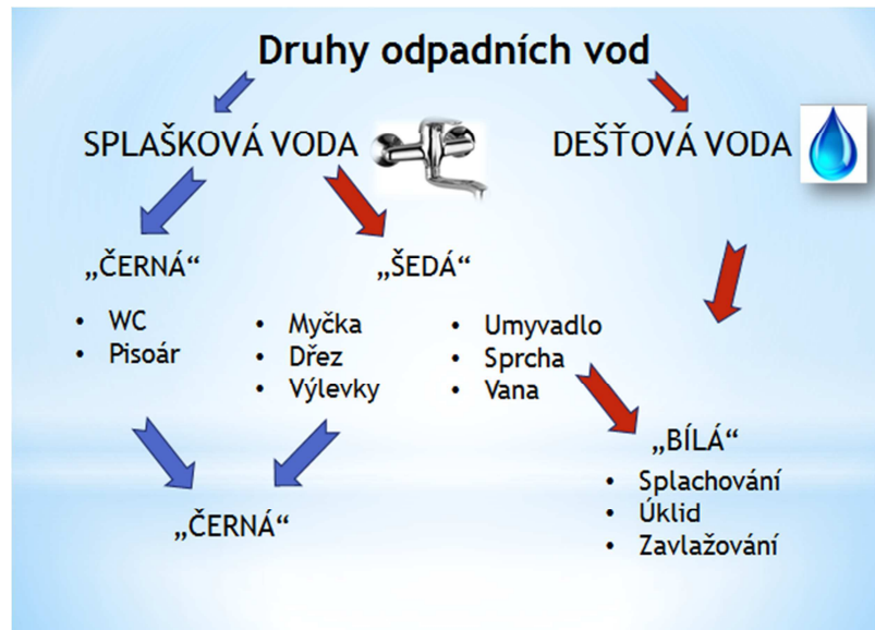
Obr. 4.1 Schéma typů odpadních vod
