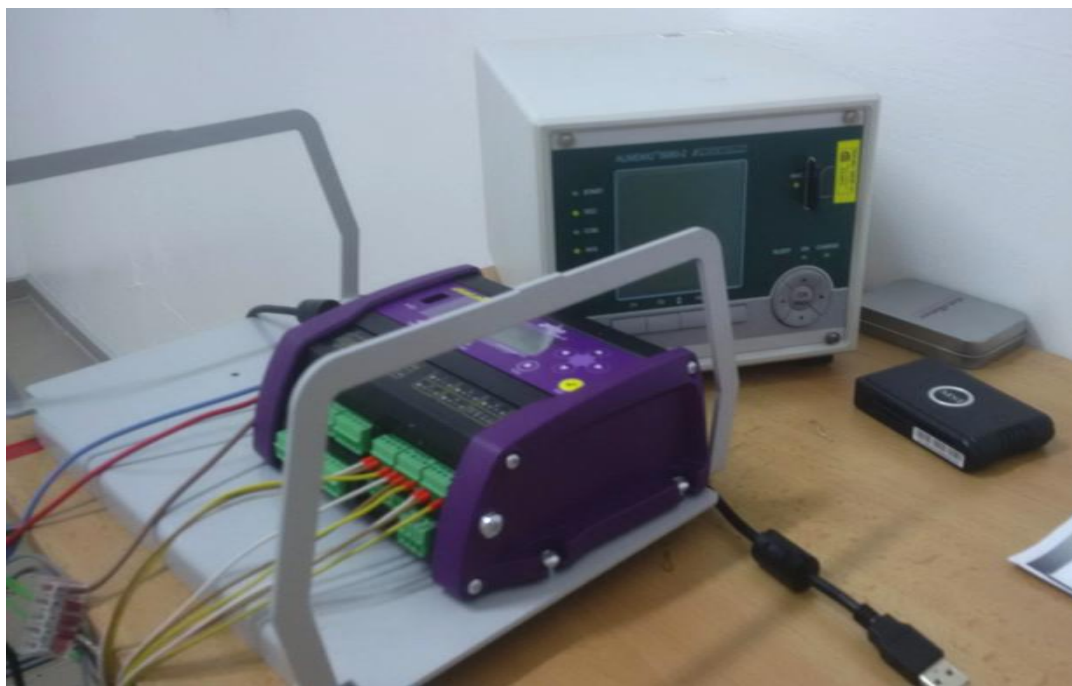
Obr. 4.5 Použité ústředny, blíže DataTaker s USB kabelem, vzadu Ahlborn, foto autor
