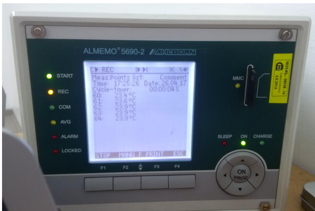
Obr. 4.6 Ústředna Ahlborn - Almemo 5690-2 s kalibračním štítkem, foto autor
