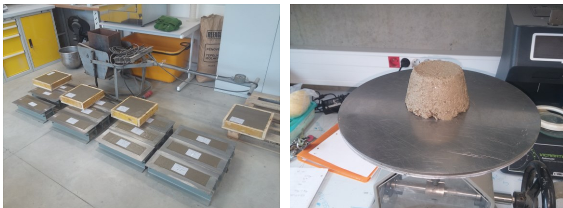
Obr. 2.1 Příprava zkušebních vzorků pro ověření vlastností aku. betonu
