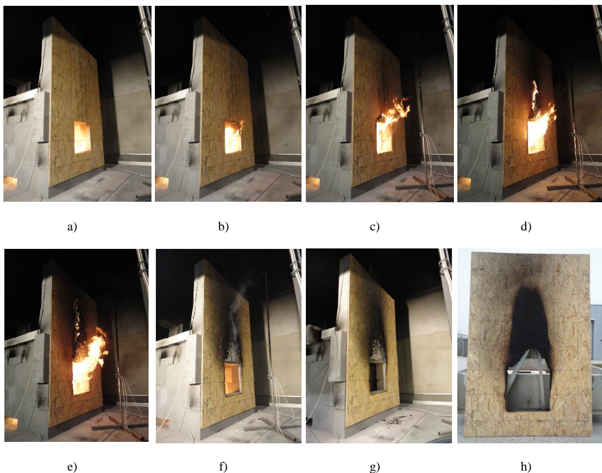
obr. 32 Průběh experimentu pece s hořlavým obkladem: a) zapálení hořáku v 0 s; b) zapálení OSB desky u pravého ostění v 2,5. min (150 s); c) šíření plamene v 7,5. min (450 s) – plamen 15 cm nad otvorem; d) šíření plamene v 15. min (900 s) – plamen 50 cm nad otvorem; e) šíření plamene v 25. min (1500 s) – plamen 85 cm nad otvorem; f) vypnutí hořáku v 3.0 min (180 s); g) odpadávání zuhelnatělé OSB desky – vytvoření torzního stínu; h) odhoření a odpadnutí hořlavého obkladu do výšky 25 cm nad nadpražím, rozšíření plamenů do výšky 90 cm nad nadpraží
