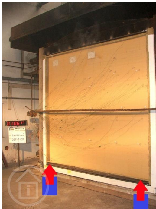
obr. 13 Zkouška požární odolnosti nosné dřevěné obvodové stěny: pohled na vzorek (3 × 3 m) nastrojený mnoha povrchovými termoelektrickými články (mezní stav I); barevně vyznačeny zatěžovací lisy [19]
