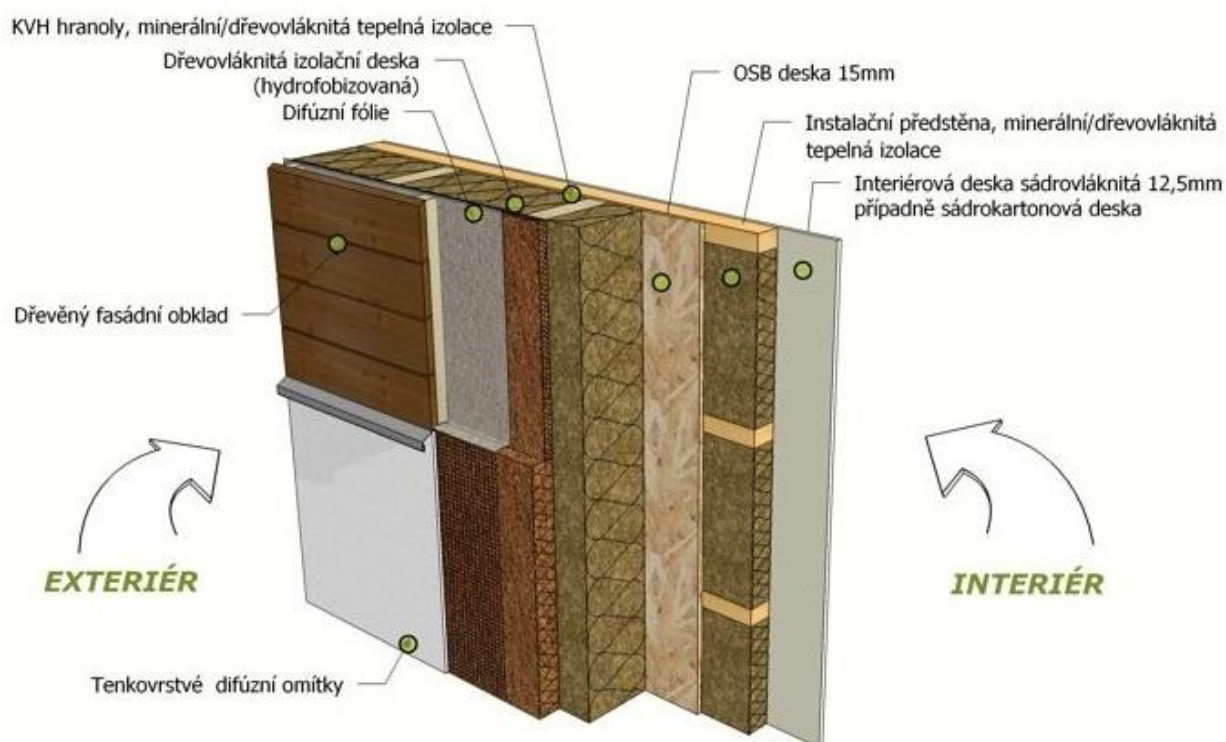
obr. 17 Skladba obvodové stěny TFH [31]
