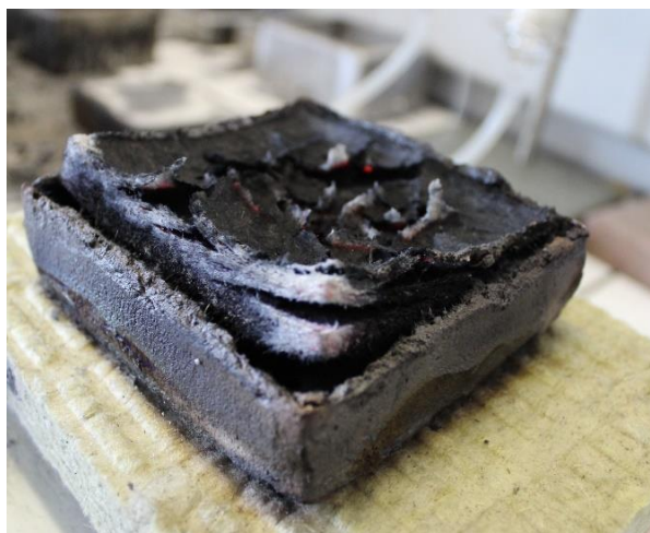
obr. 24 Vzorek 3: viditelná deformace dřevovláknité desky s omítkou po zkoušce
