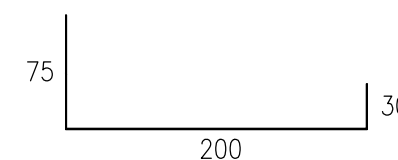
PROFIL TVARU U Z FEZN, R.Š.305MM, TL.1,25MM M 1:5
