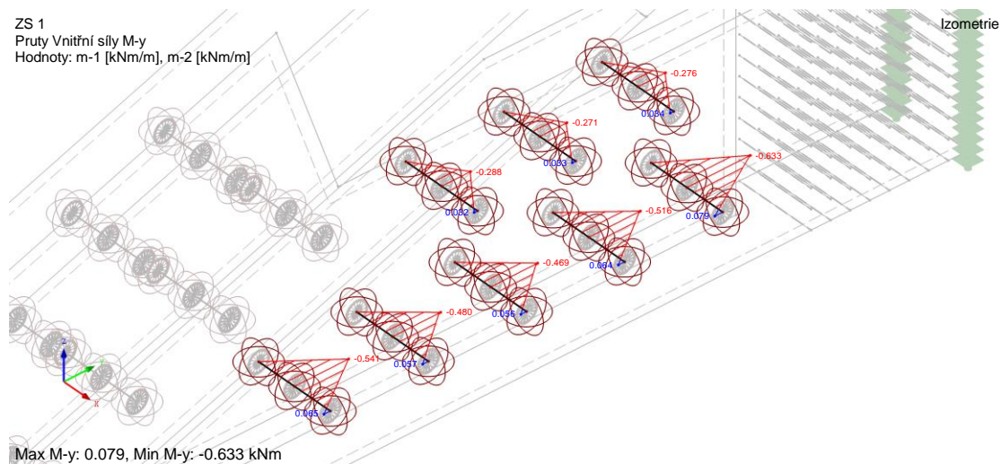
Obrázek 58 – Ohybový moment ve svornících podle výpočetního modelu
