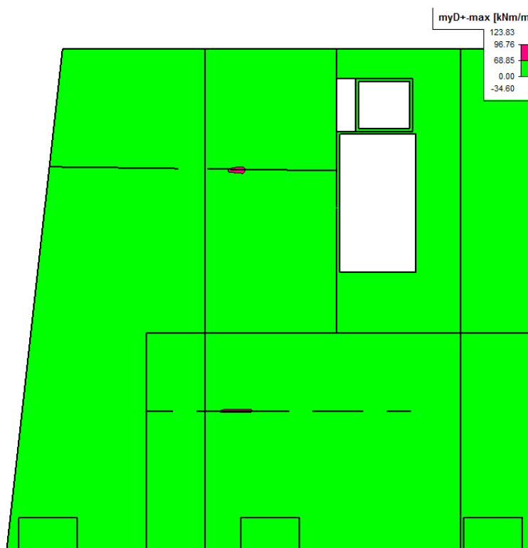
Obrázek 2.65. Izopásma navržené výztuže - horní ve směru Y.
